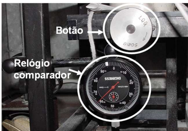
Figura 4.11 – Sistema de controle da altura da plataforma de construção.
