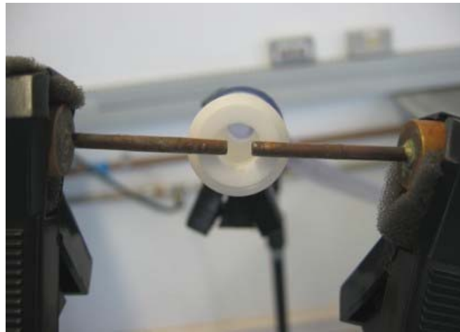
Figura 56 – Posicionamento das ponteiros para obtenção da H(f) de calibração.
