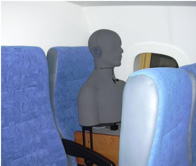
Figura 2.11: Cabeça e torso artificiais do Laboratório de Vibrações e Acústica da Universidade Federal de Santa Catarina, dentro de uma sala de testes que simula o interior de um avião.
