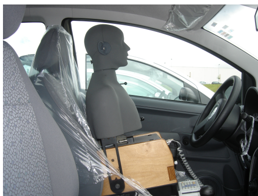
Figura 4.1: Posicionamento da cabeça e torso artificiais dentro do automóvel.
