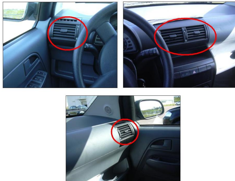
Figura 3.5: O ajuste das saídas de ar: posicionadas no centro e para baixo. Além disso, as válvulas eram abertas.
