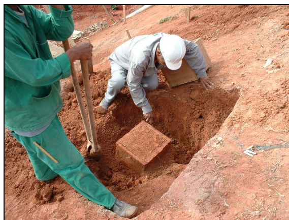
Figura 29 – Detalhe da modelagem e da amostra.
