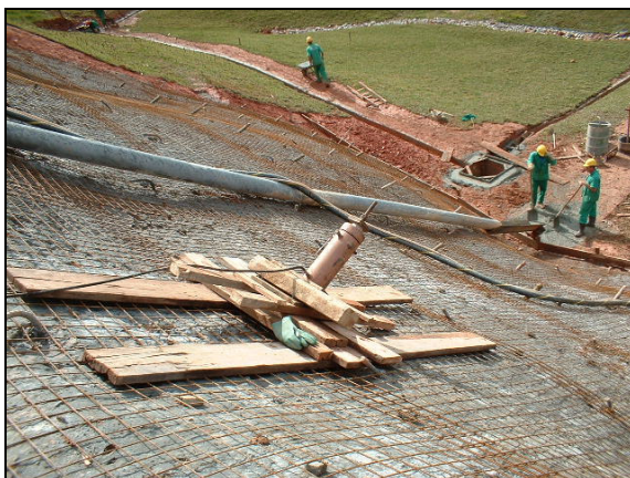
Figura 25 – Localização do macaco hidráulico para a realização do ensaio.
