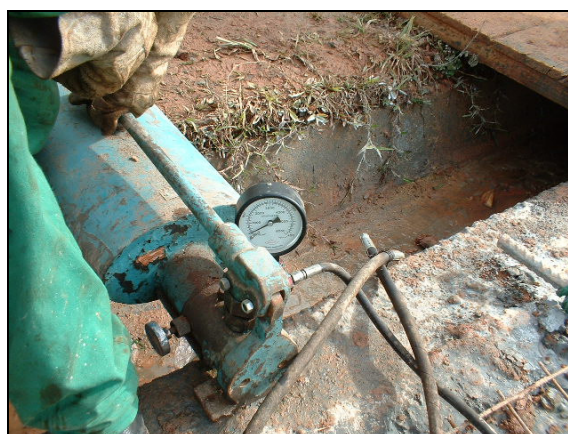
Figura 27 – Detalhe do manômetro utilizado para medir a pressão.
