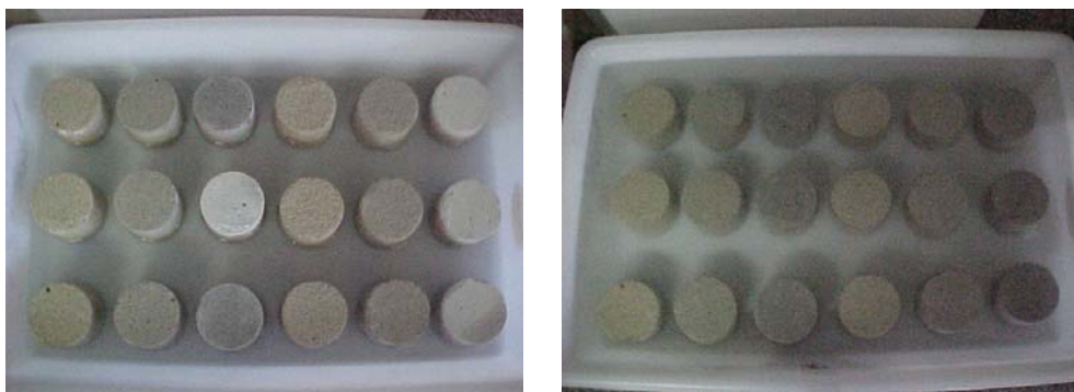
Figura 31: Ensaio de absorção de água por imersão
