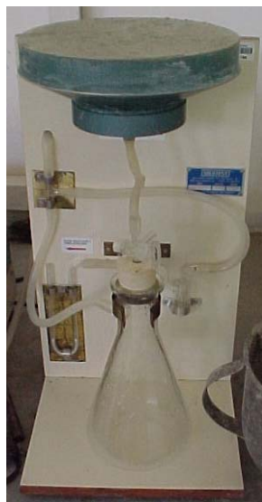
Figura 29: Aparato utilizado no ensaio de retenção de água
