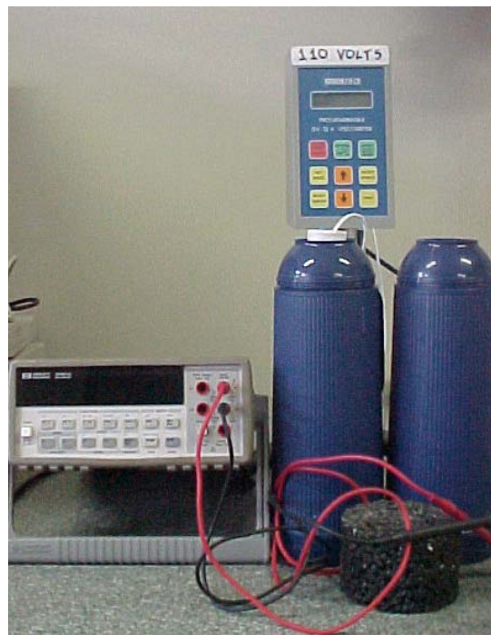
Figura 37: Aparato para calibração do termopar
