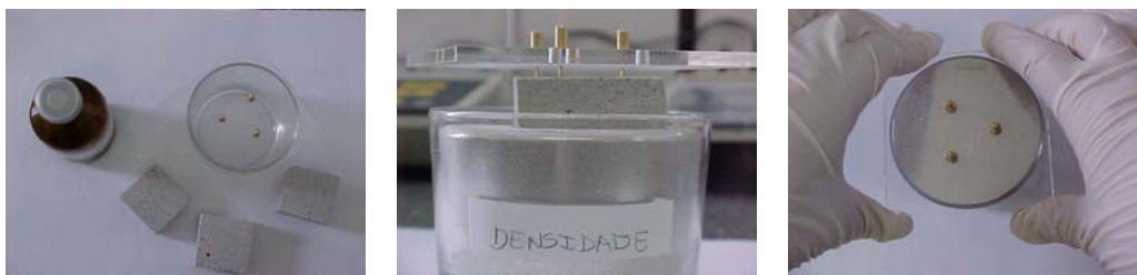
Figura 30: Aparato utilizado para a determinação da massa específica das amostras
