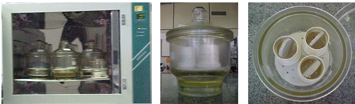
Figura 33: Aparato experimental do ensaio de adsorção
