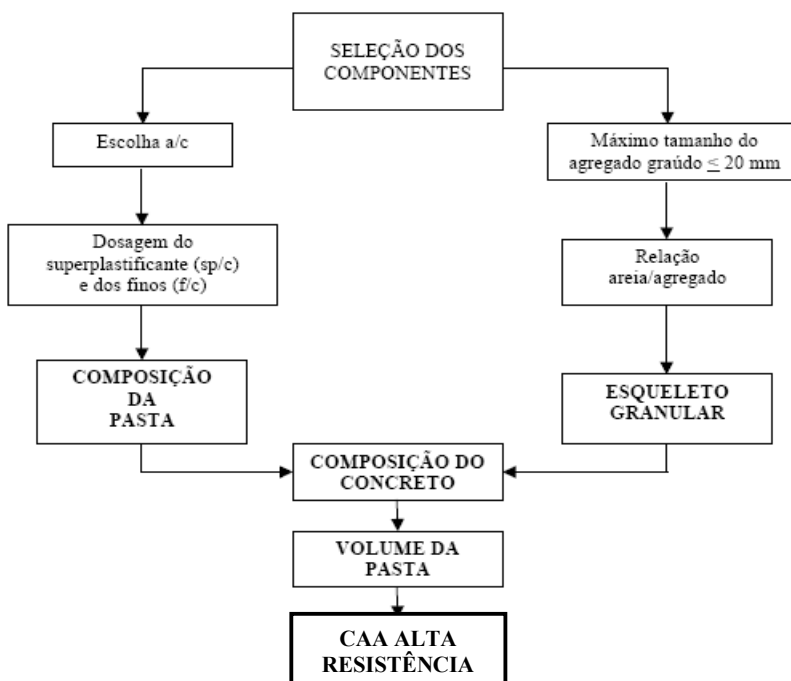
Figura 24 - Metodologia de dosagem para o CAA de Alta Resistência proposta por Gomes, 2002.
