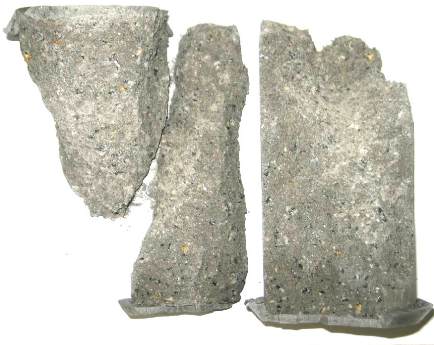
Figura 73 - Concreto rompido com filer e 40% de areia na argamassa.
