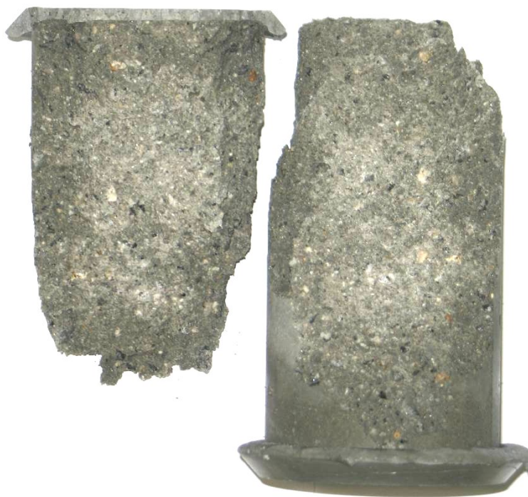
Figura 74 - Concreto rompido com APV e 50% de areia na argamassa.
