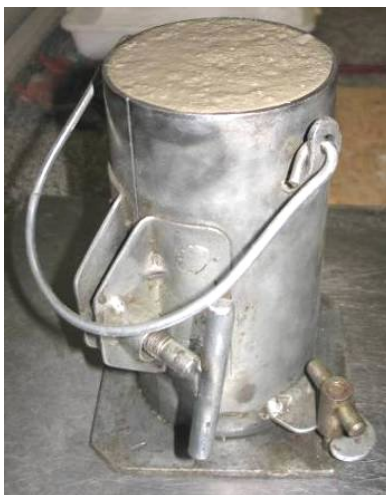
Figura 48 - Molde metálico cilíndrico de concreto.
