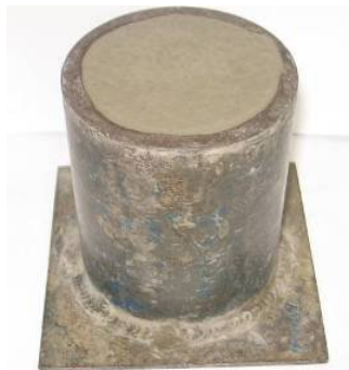
Figura 38 - Molde metálico cilíndrico de volume conhecido.
