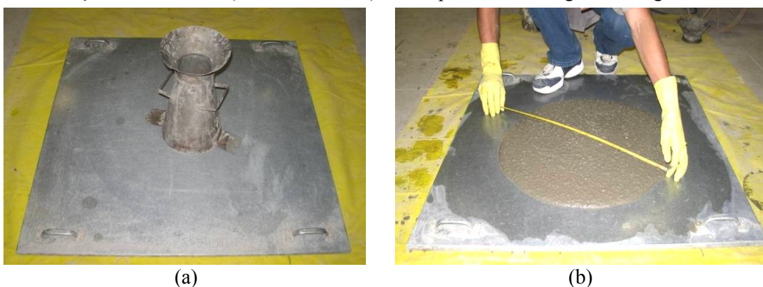
Figura 45 - Ensaio de espalhamento para o CAA.
