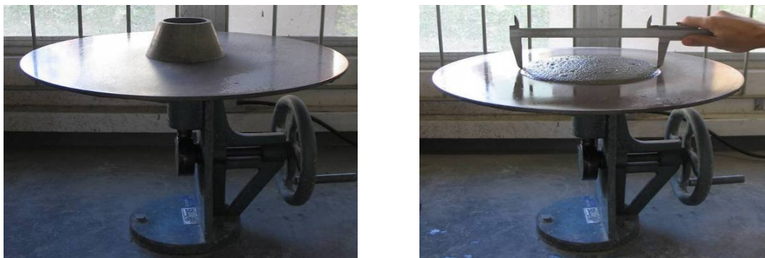
Figura 36 - Cone metálico (a) para ensaio de espalhamento ( slump flow ) em argamassa(b).
