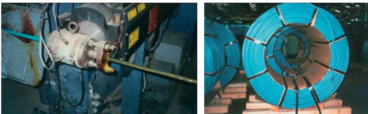
Figura 1: Detalhes da extrusão e de uma bobina de 3 ton. da cordoalha engraxada de diâmetro \varnothing 12,7\text{mm}
