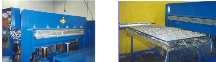
Figura 15: Prensa e forma utilizadas para a confecção de placas. (Fonte: CERQUEIRA, 2005).
