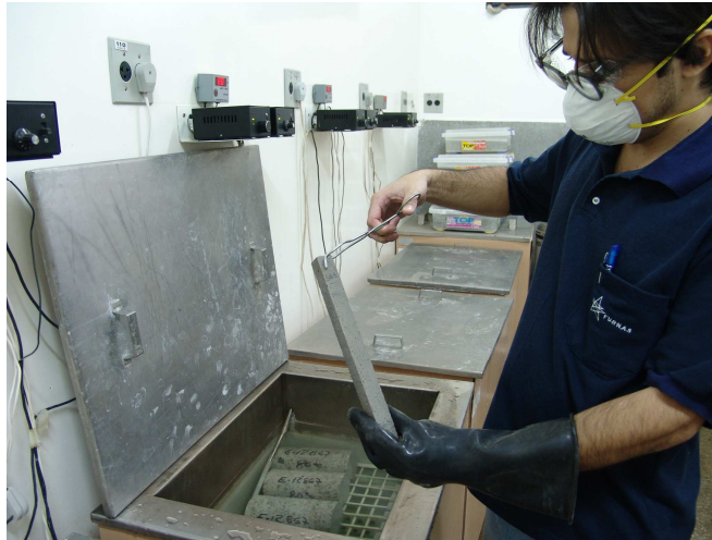
Figura 4.18 – Retirada das barras do tanque para leitura inicial
