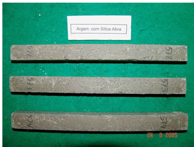
Figura 4.17 – Argamassa com SA no dia da desmoldagem
