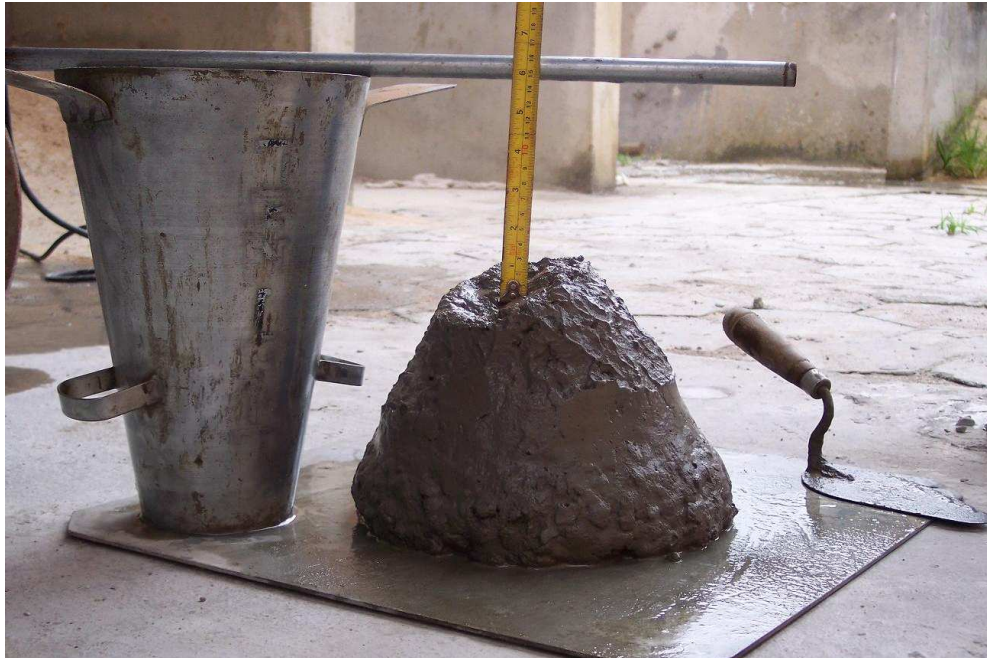
Figura 4.8 - Concreto com CCA, a/c = 0,4
