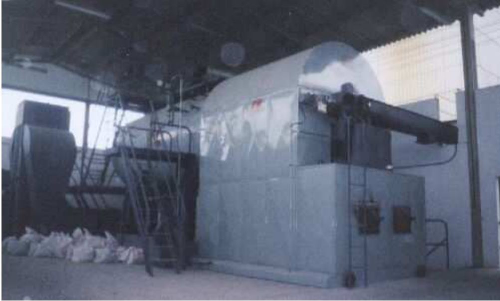
Figura 4.2 – Queimador compacto tipo “Biocham”
