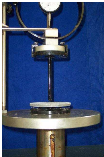
Figura 4.14 – Amostra preparada para o ensaio de ensaio de resistência à flexão
