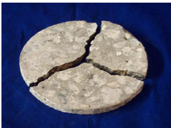
Figura 5.16 – Padrão de ruptura das fatias de concreto
