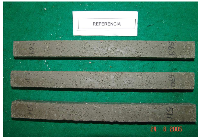
Figura 4.15 – Argamassa de referência, no dia da desmoldagem
