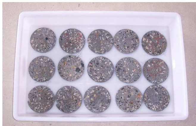
Figura 4.9 – Fatias de concreto para avaliação do ataque por sulfato
