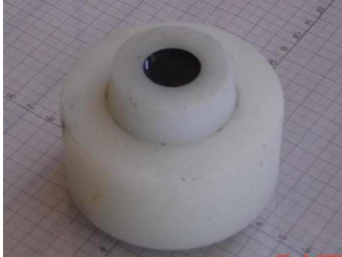
Figura 4.7 – Equipamento para ensaio de Cone de Kantro
