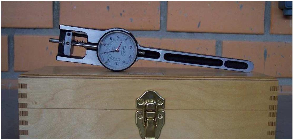
Figura 4.10 – Alongômetro utilizado para as medidas de expansão por ataque de sulfatos
