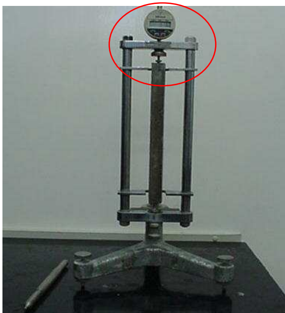
Figura 4.19 – Medida da barra realizada no conjunto suporte e relógio comparador digital
