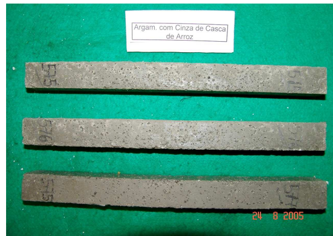
Figura 4.15 – Argamassa de referência, no dia da desmoldagem
