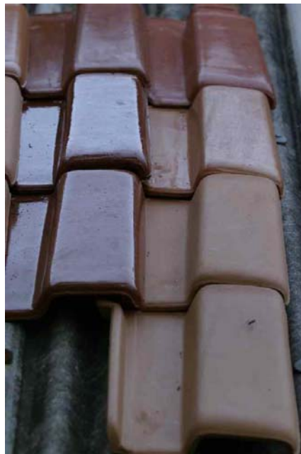
Figura 4.9 – Corpos de prova utilizados no ensaio de resistência ao tempo.
