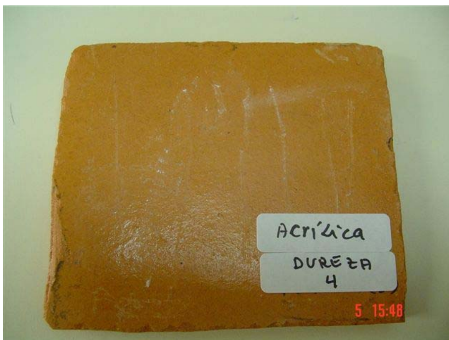
Figura 5.16 – Corpo de prova com recobrimento superficial acrílico após a execução do ensaio de resistência ao risco.
