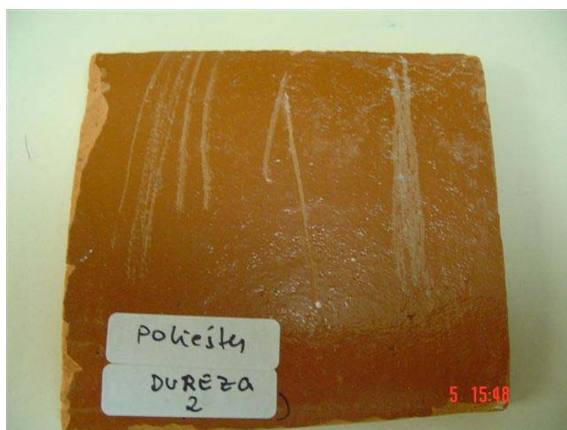
Figura 5.17 – Corpo de prova com recobrimento superficial de poliéster após a execução do ensaio de resistência ao risco.
