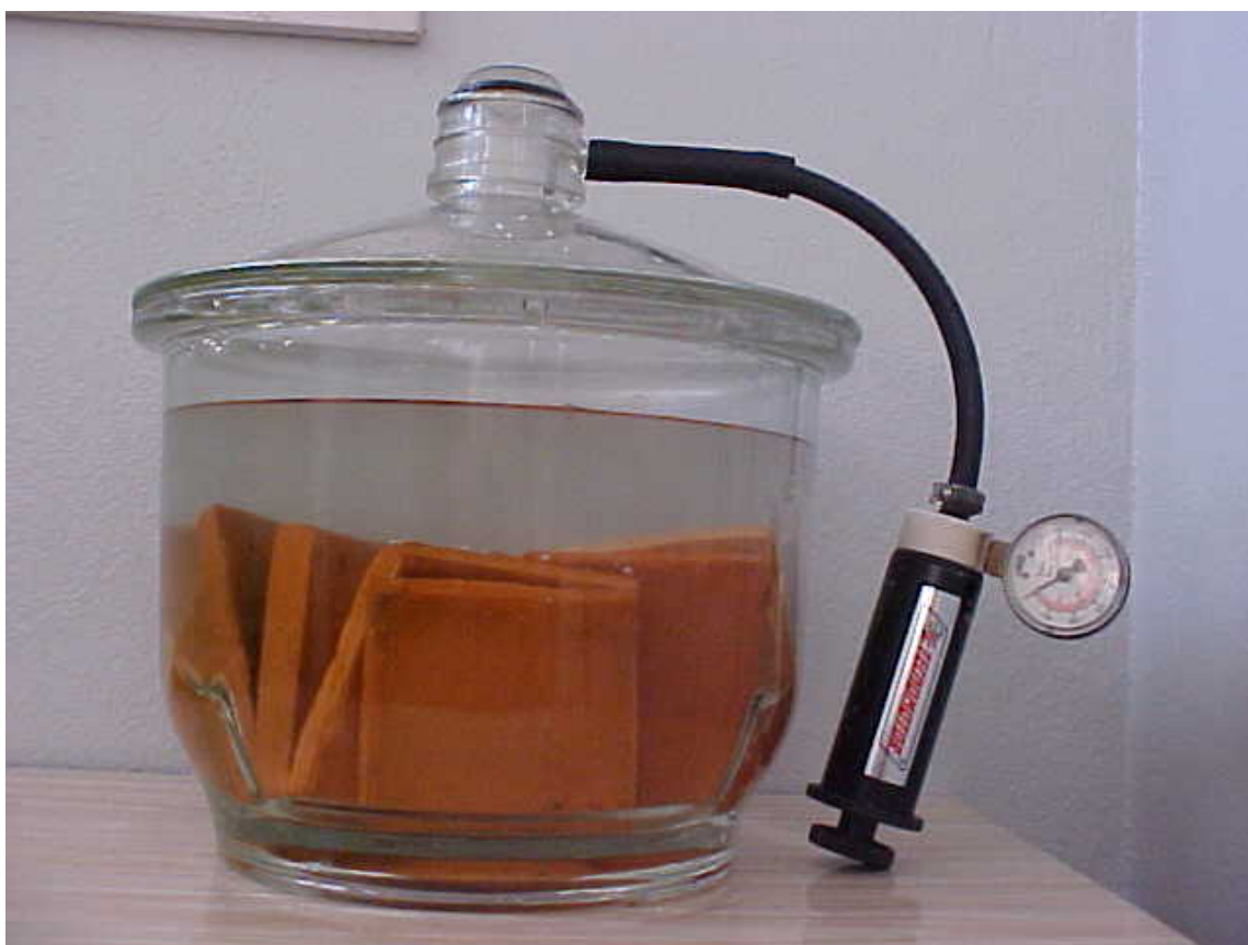
Figura 4.10 - Campânula de vácuo e bomba de vácuo para extração do ar e impregnação com água para o ensaio de congelamento.
