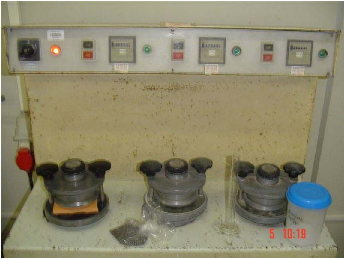
Figura 4.7 Abrasímetro – Equipamento utilizado no ensaio de resistência à abrasão.
