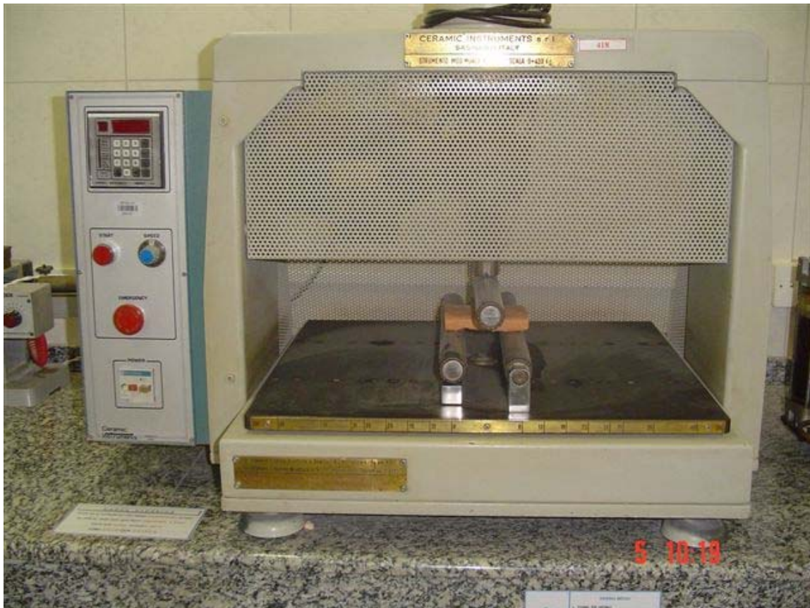
Figura 4.6 Deflectômetro – Equipamento utilizado no ensaio de resistência à flexão.
