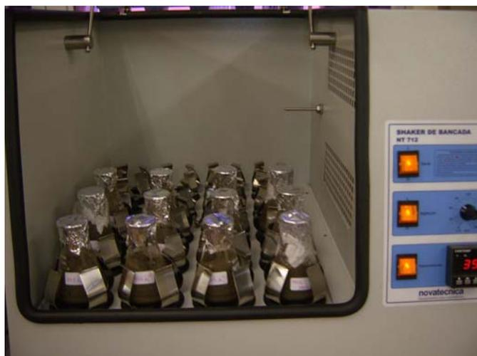
**Figura 3.4. Ensaio de Biodegradação de pireno em sedimentos superficiais do manguezal do Itacorubi.**
