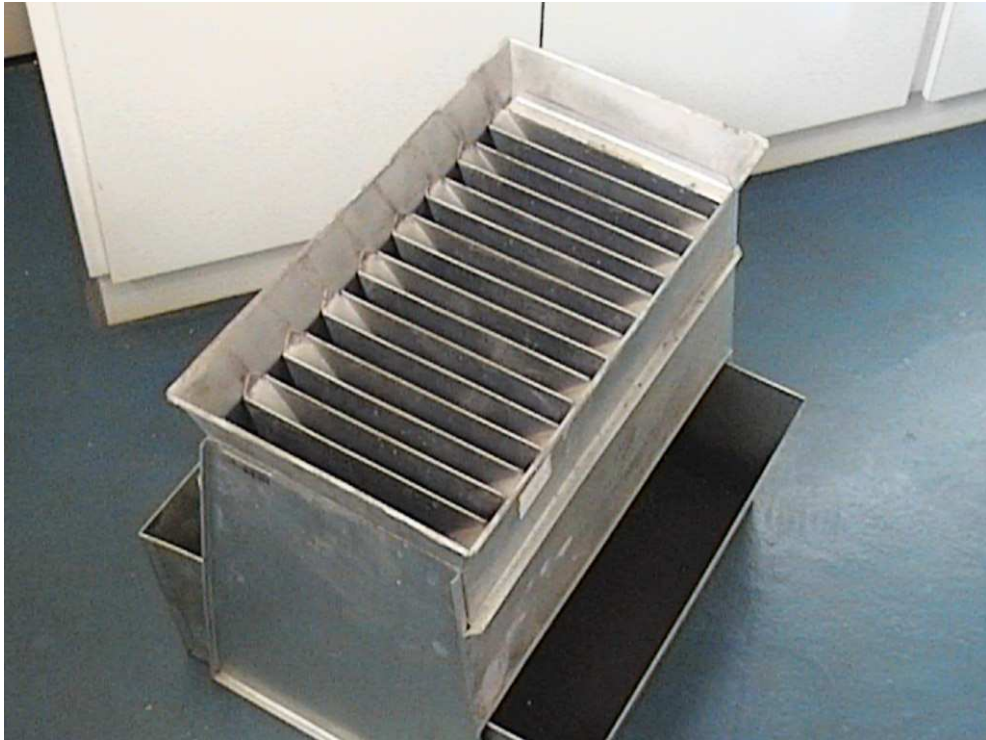
FIGURA 16 - Equipamento repartidor de amostras
