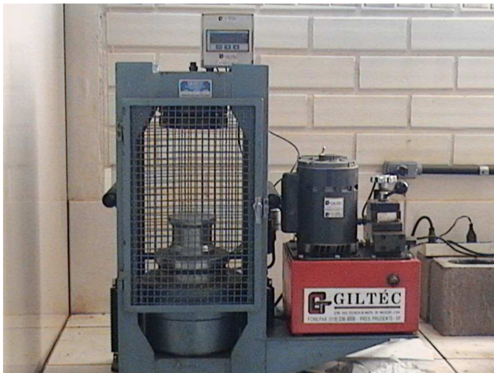
FIGURA 19 - Aparelhagem para determinação de carga de compressão axial
