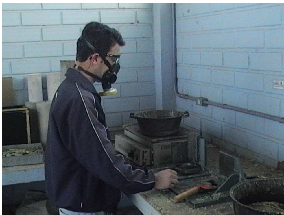
FIGURA 18 - Procedimento de capeamento das amostras
