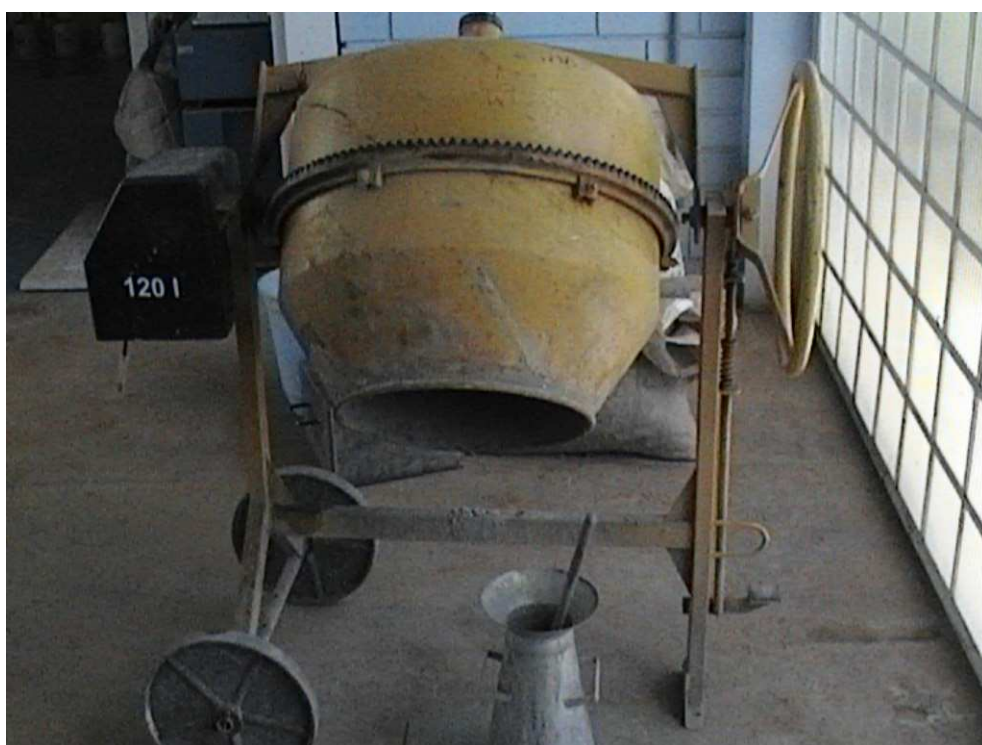
FIGURA 17 - Misturador e aparato para determinação da consistência
