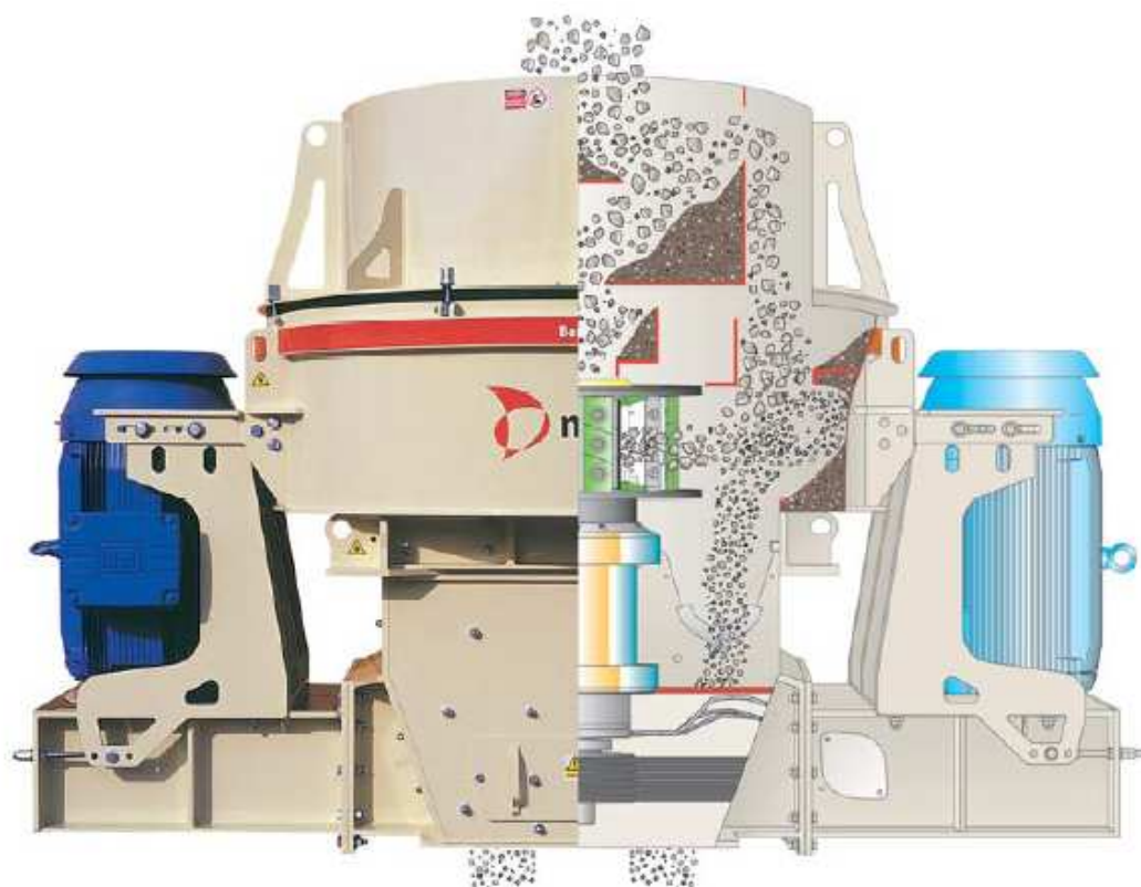
FIGURA 4 - Ilustração esquemática do funcionamento do britador de impacto de eixo vertical rocha contra rocha
