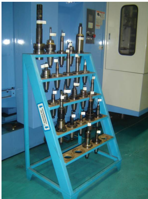
Figura 5.4 – Estante para armazenamento de ferramentas ao lado da máquina
