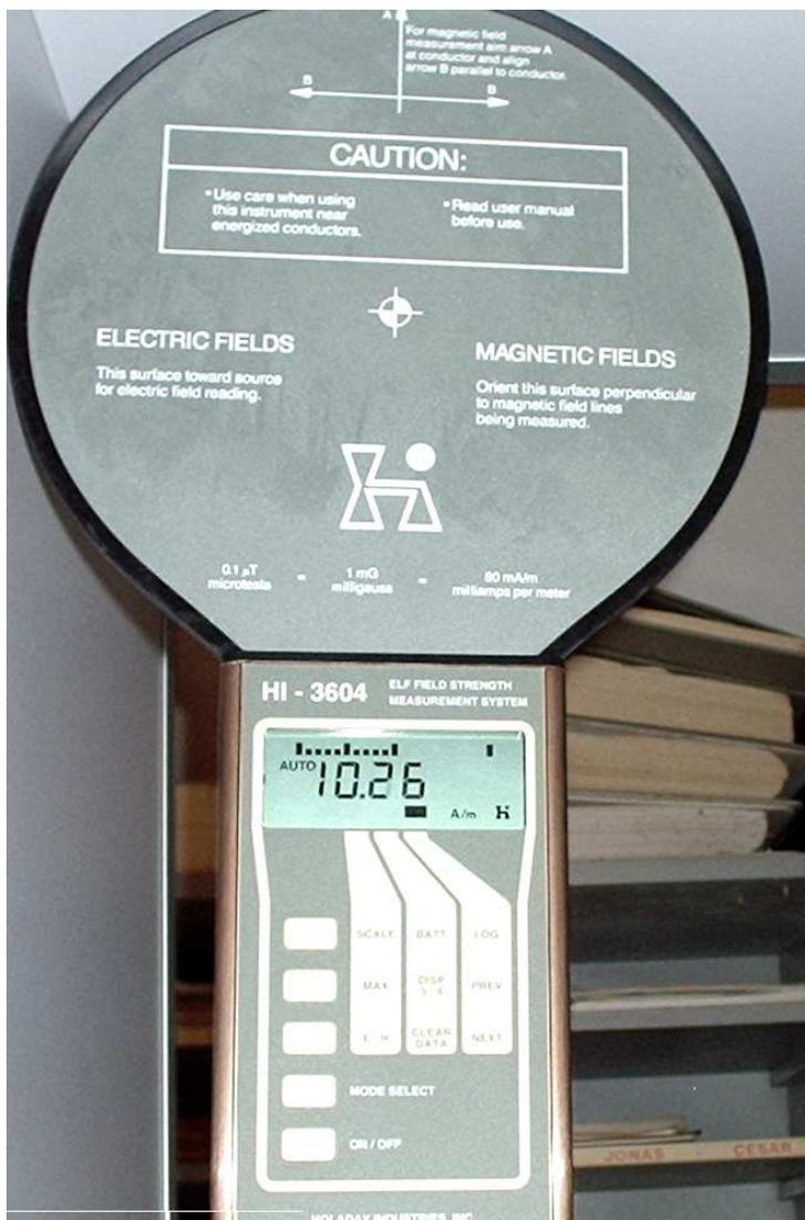
B1 – Medidor de campos eletromagnéticos.
