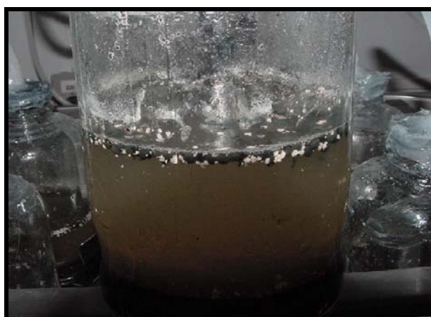
Figura 26. Enzima LNU precipitada durante os ensaios de biodegradabilidade.
