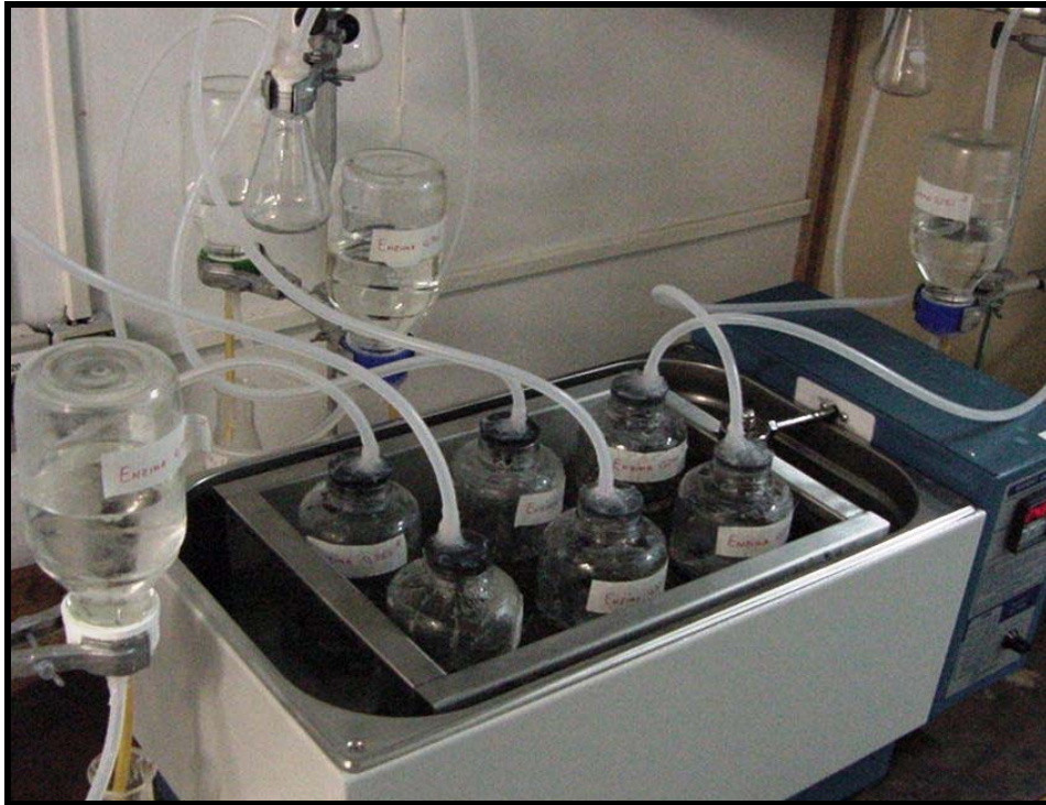
Figura 6. Aparato experimental utilizado nos ensaios de biodegradabilidade.
