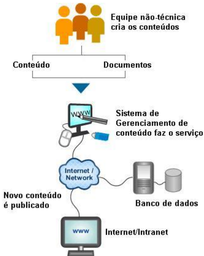
Figura 3.6 – Funcionamento de um CMS (adaptado de BIZEXPRESS, 2006)
