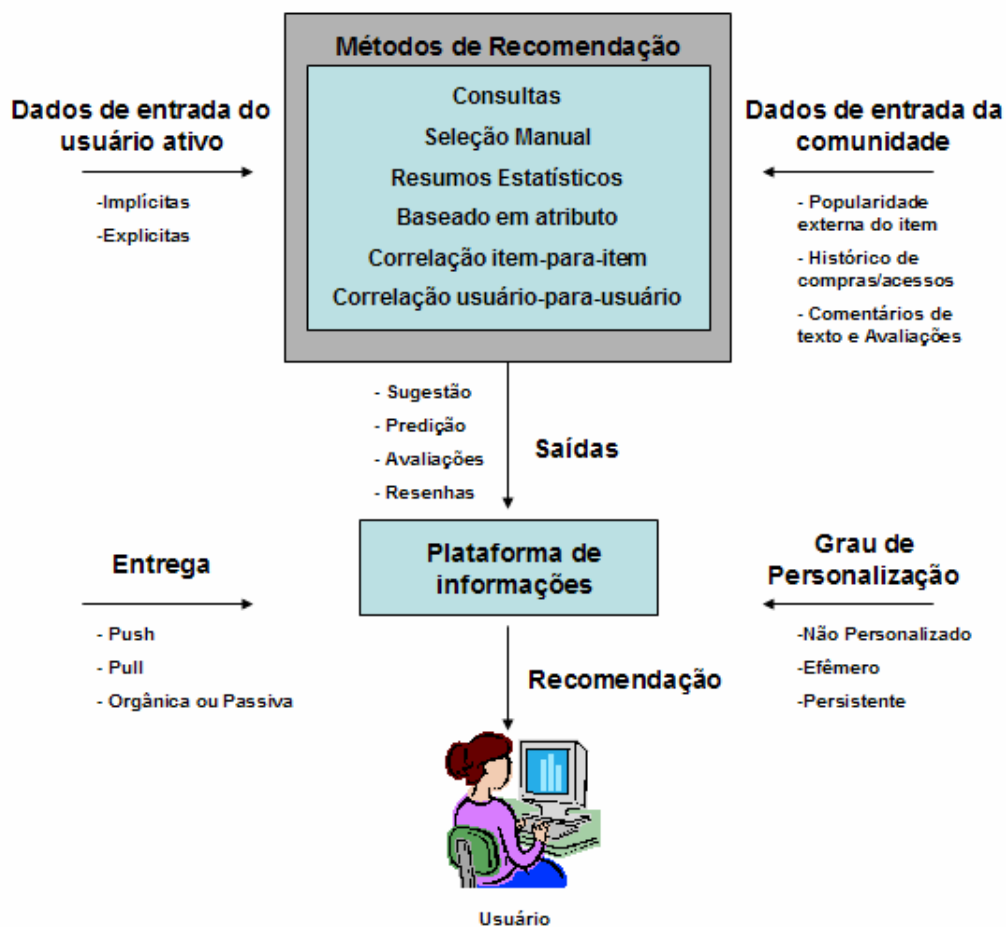
Figura 3.2 – Classificação de sistemas de recomendação. A recomendação é gerada a partir das entradas do usuário ativo e os dados de entrada da comunidade (adaptado de TORRES, 2004).
