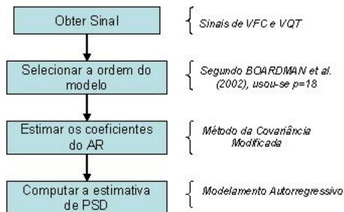
Figura 3.12: Diagrama de blocos correspondente aos passos para a estimativa de densidade espectral de potência (PSD), através do modelamento AR.
