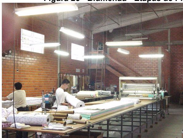
enfesto manual e corte mecânico
