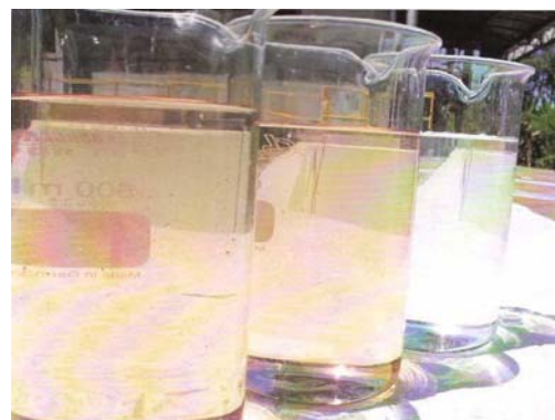
Figura 23: Amostras de água após o tratamento na ETE (à esquerda), depois da filtração pelo quartzo (no meio) e após a filtração pela resina (à direita).
