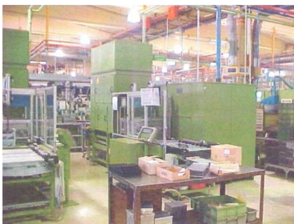
Figura 36: Uma das máquinas de lavagem a base de solvente aquoso e desengraxante alcalino. Fonte: Prêmio Expressão de Ecologia.
