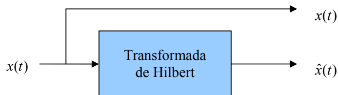
Figura 3.2: Geração de um sinal analítico utilizando transformada de Hilbert.
