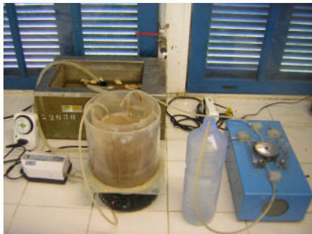
Figura IV.1: Sistema experimental utilizado para o estabelecimento do processo de nitrificação autotrófica e nitrificação parcial.
