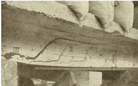
Figura 3.10 – Ruptura por força cortante-tração diagonal (MÖRSCH, 1959)
