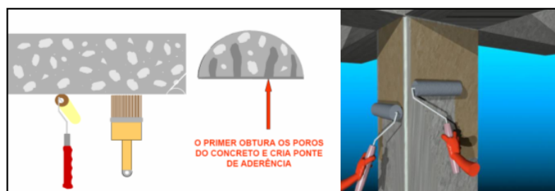
Figura 2.14 – Aplicação do imprimador primário (Primer) (MACHADO, 2006)
