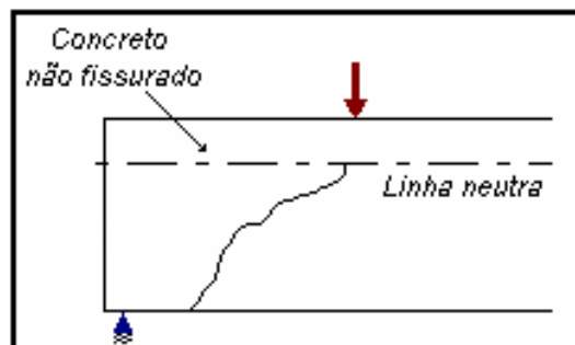
Figura 3.7 – Resistência do Concreto não fissurado ( O'BRIEN & DIXON, 1994)
