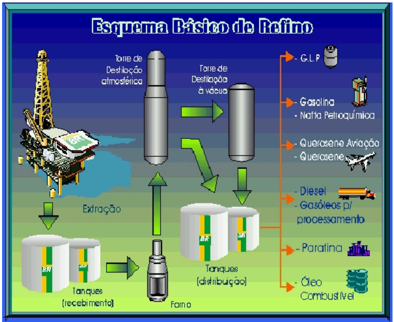
Figura 2.1: Esquema básico de refino na indústria de petróleo (Revista Petrobras, 2004).
