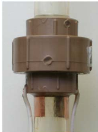
Figura 3.12 – Eletrodos de cobre instalados.
