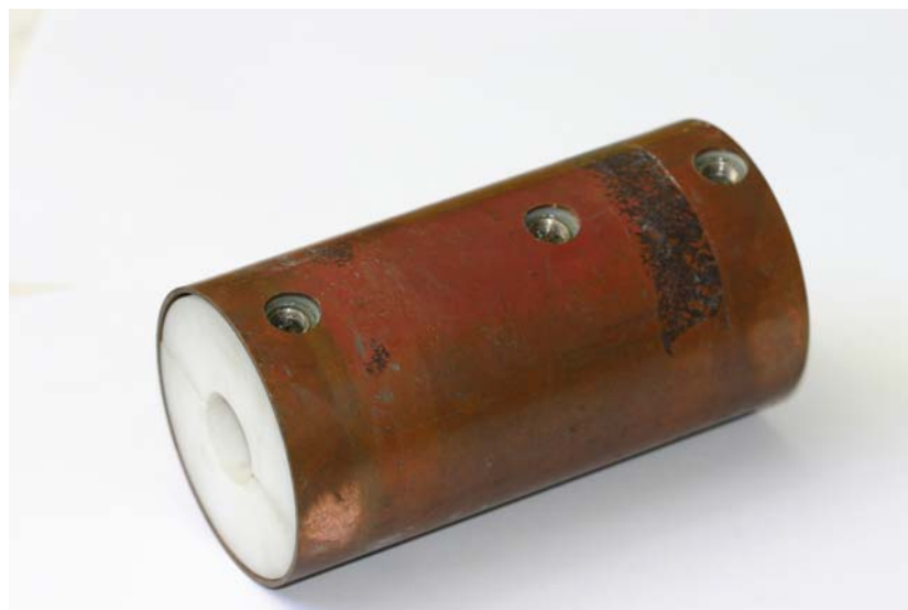
Figura II.5 – Montagem do sistema de blindagem.
