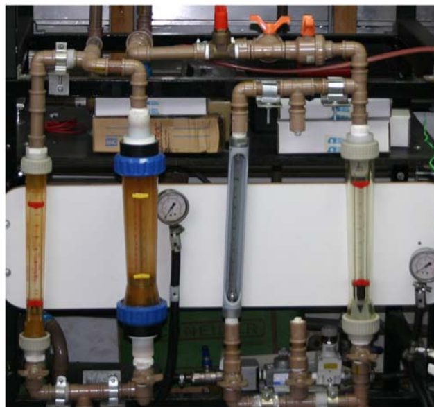
Figura 3.11 – Rotâmetros para água (à esquerda) e para ar (à direita).
