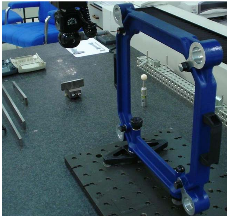
Figura 39 – Protótipo alfa do Quadra Mensura (400 x 400 mm).
