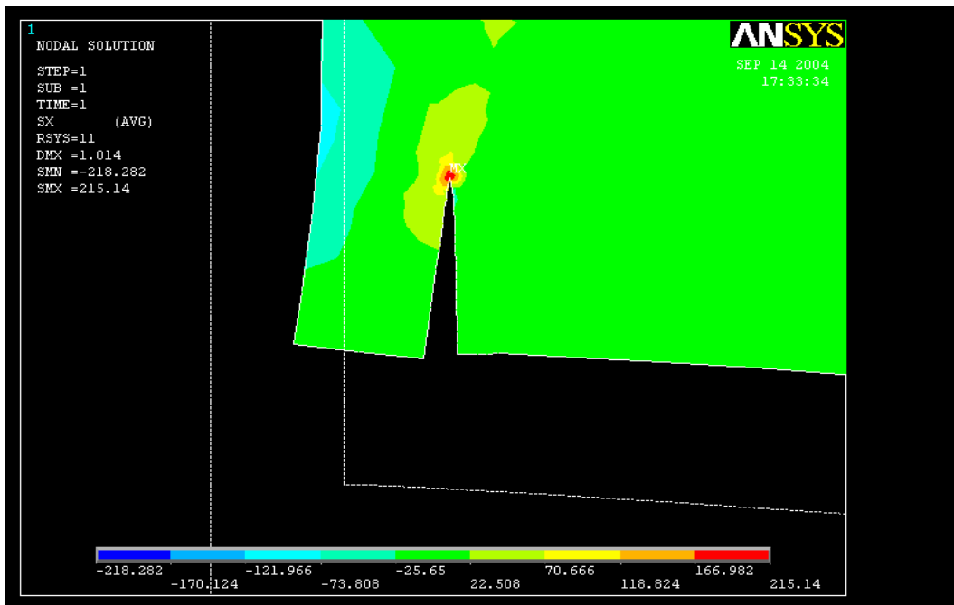
Figura 4.6 – Detalhe do mapeamento das tensões no eixo X, ponta da trinca
