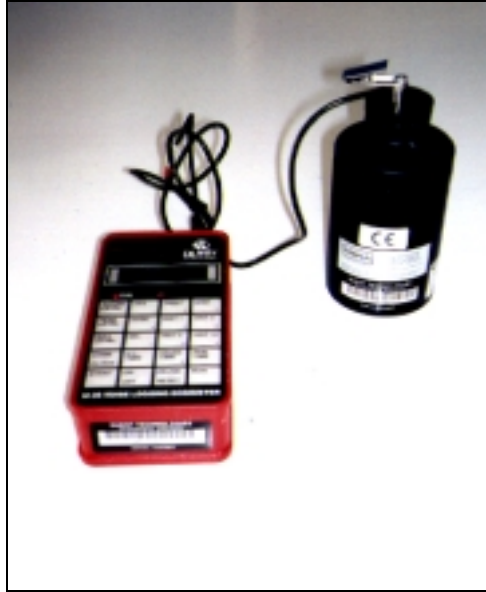
Figura 3.6: Calibrador da marca Quest , modelo QC – 10, calibrando o dosímetro M28.
