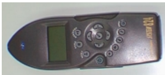
Figura 3.3: Medidor de NPS com filtro marca Larson Davis.
