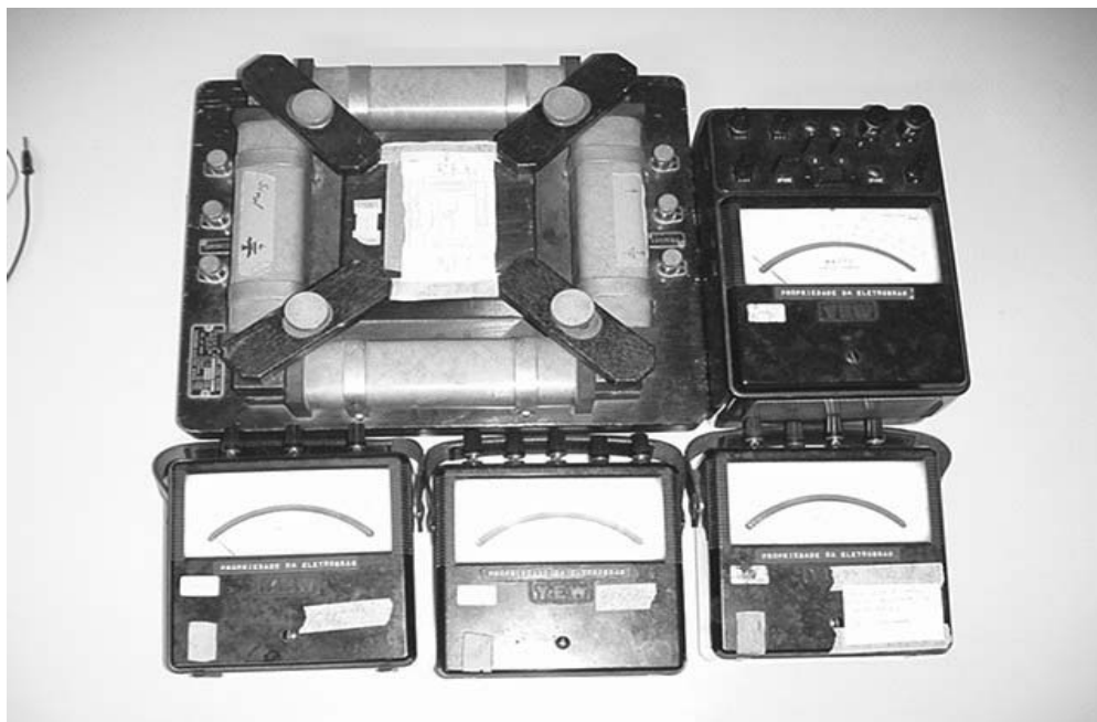
Fig. A2: Equipamentos convencionais e padronizados conforme a NBR5161, utilizados nos ensaios.
