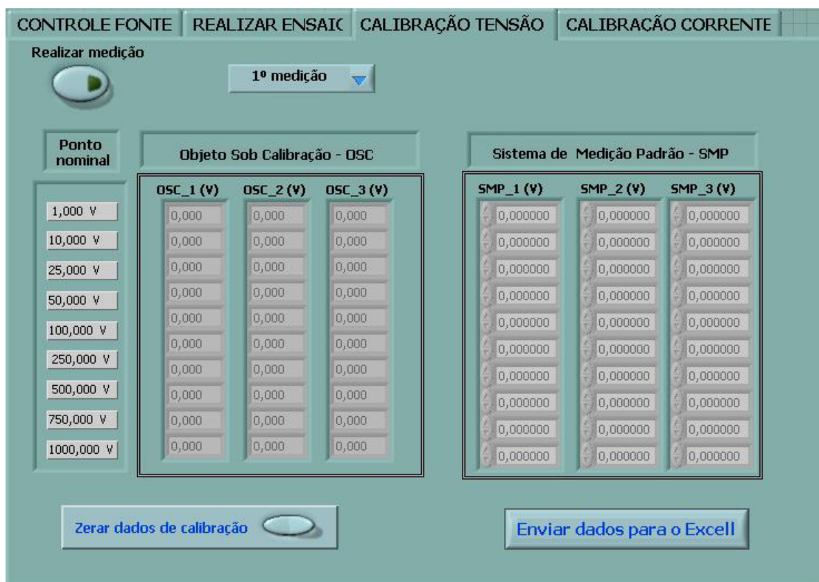
Figura 17: Painel frontal calibração da tensão
