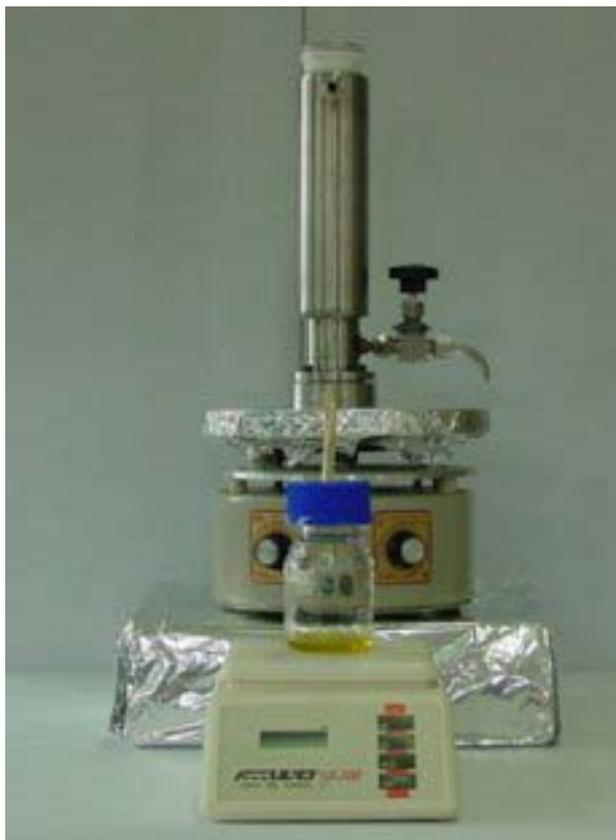
**Figura 5** – Fotografia da célula de ultrafiltração perpendicular utilizada nos experimentos
