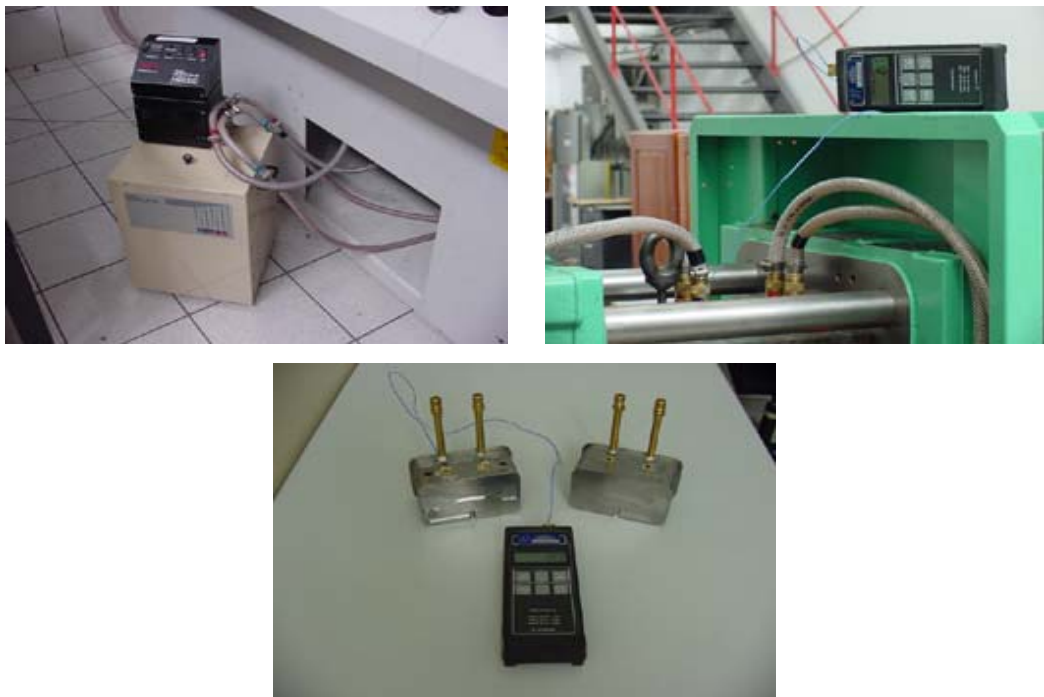
Figura 4.4 – Detalhes do equipamento de aquecimento (esquerda superior), equipamento para medição de temperatura do inserto (direita superior) e do conjunto inserto de aço e sistema de medição de temperatura.
