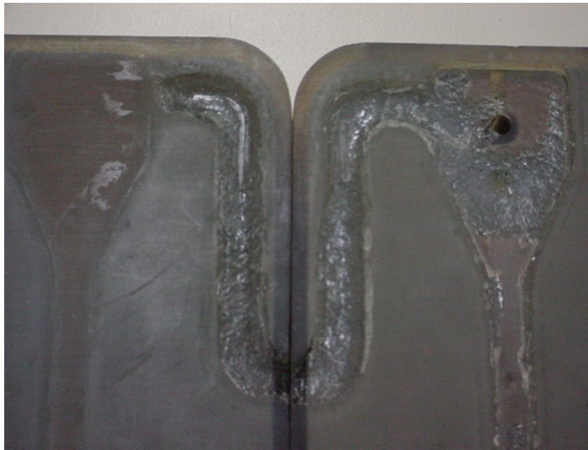
Figura 5.30 – Superfície do inserto de estereolitografia após moldagem do PA 6,6.
