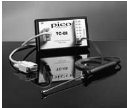
Figura 4.5 – Sistema de aquisição de sinais Pico Log – TC 08 (PICO, 2003).
