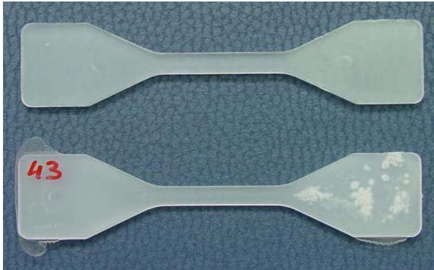
Figura 5.3 – Peças em polipropileno antes e após a fase de ajustamento.
