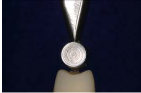
Figura 68 - Visão da barra cilíndrica sobre o corpo de prova com aumento de 3x. Foto de caráter ilustrativo em que aparece uma gotícula deixada propositalmente entre a peça cerâmica e a barra.
