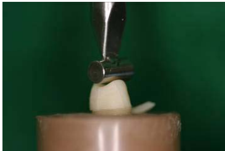
Figura 69 - Fratura da peça cerâmica durante o teste de compressão. Note que é possível observar as linhas de fratura (trincas) e um pedaço da peça já separado do dente.
