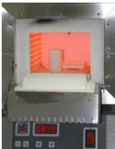
Figura 51 - Colocação do cilindro e haste do êmbolo no forno EDG3000 (EDG) para pré-aquecimento.
