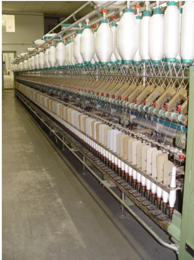
Figura 9 – Filatório de anel utilizado para fabricação de fio singelo.
