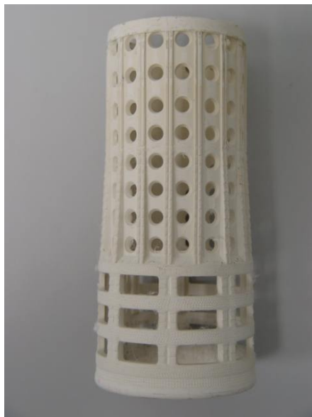
Figura 16 – Conical perfurado utilizado nos tingimentos.
