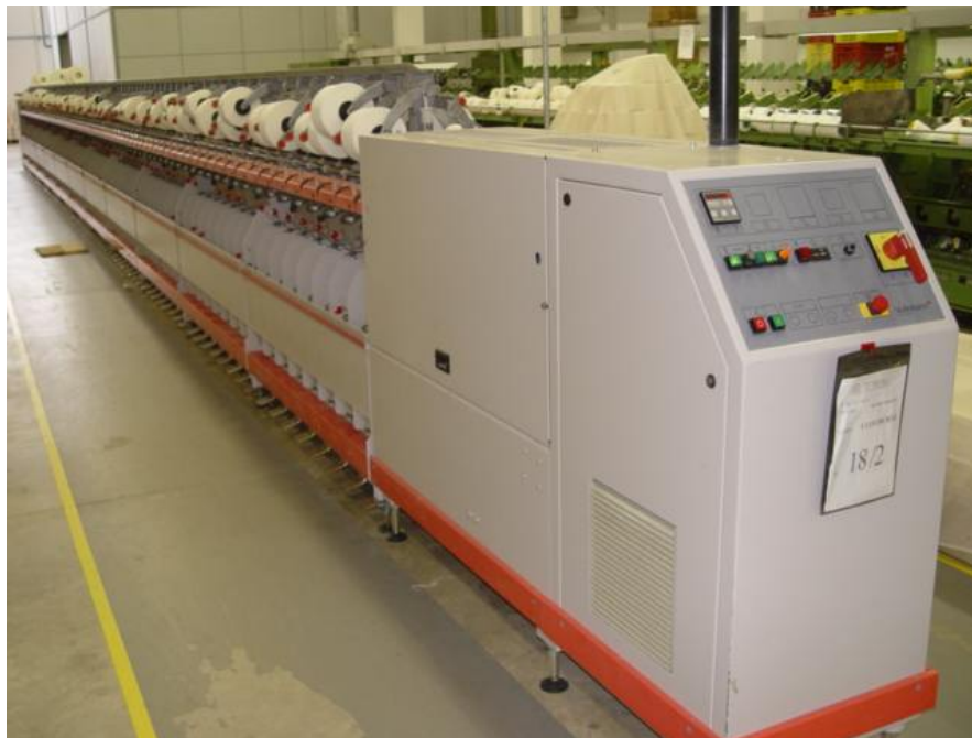
Figura 10 – Retorcedeira utilizada para a retorção dos fios.
