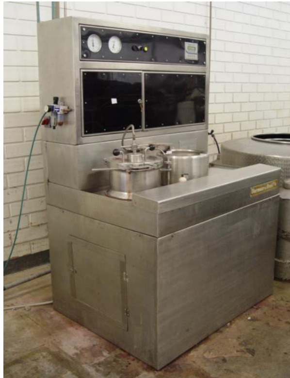
Figura 11 – Equipamento para tingimento de fio em bobina em escala piloto (Obermaier do Brasil Ltda).
