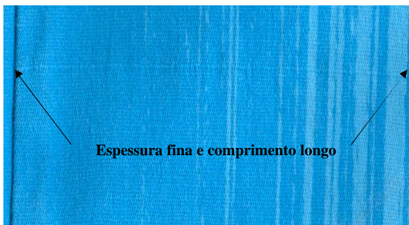
Figura 5.7 – Característico defeituoso fio grosso ou falta de fio de espessura fina e comprimento longo da amostra 6
