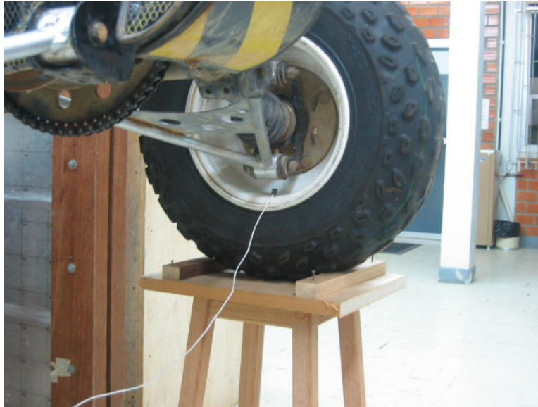
Figura 5.5: Colocação do acelerômetro na roda traseira direita.
