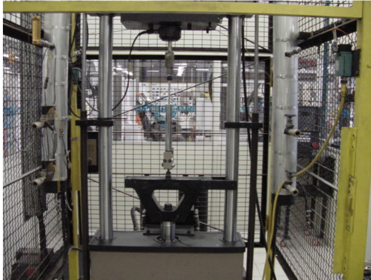
Figura 4.10: Ensaio de caracterização do amortecedor
