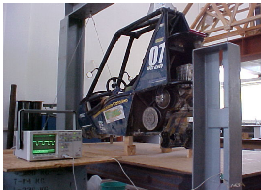
Figura 4.29: Medição do momento de inércia em torno do eixo longitudinal.
