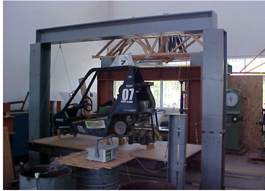
Figura 4.27: Pórtico construído para a realização do ensaio.
