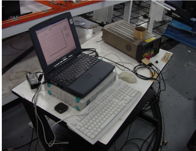
Figura 4.13: Montagem dos equipamentos Spyder (sob o computador) e MTS para o ensaio de caracterização da rigidez do pneu.
