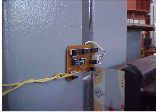
Figura 4.30: Sensor de mouse utilizado para a medição do período de oscilação.
