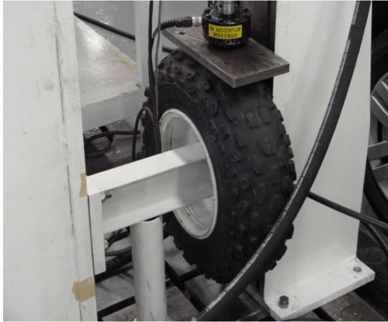
Figura 4.11: Dispositivo utilizado para fixação e suspensão da roda em relação ao solo.
