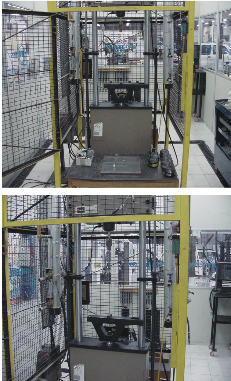
Figura 4.2: Equipamento de ensaio MTS utilizado para caracterização das molas e amortecedores.
