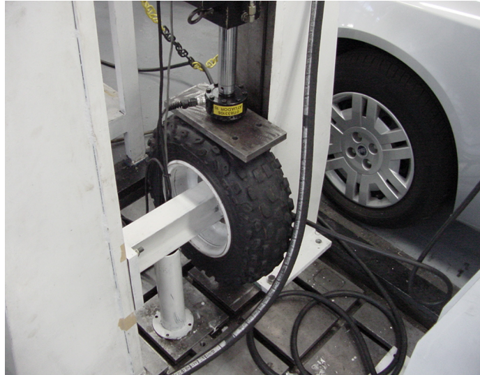
Figura 4.25: Aplicação da carga vertical sobre o pneu.
