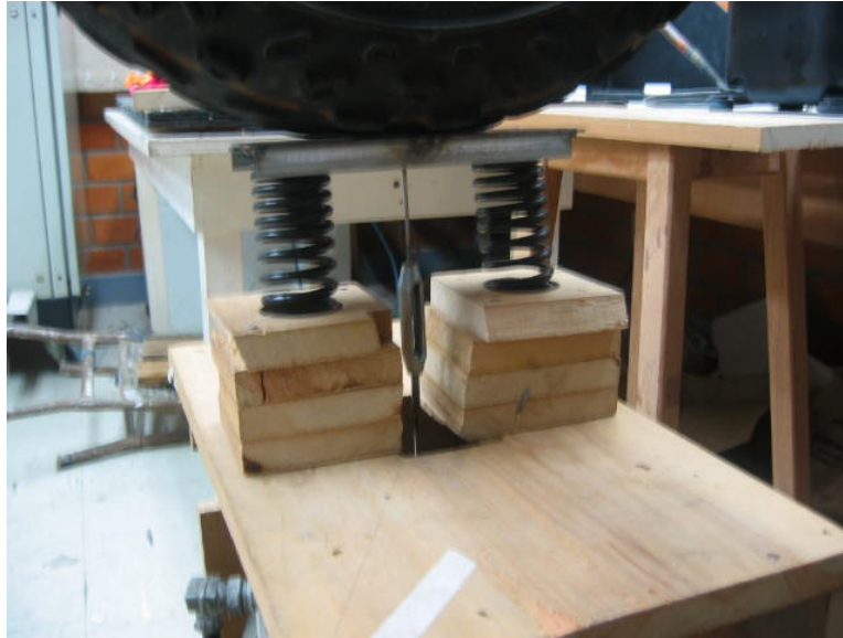
Figura 5.3: Stinger construído a partir de um esticador de cabo de aço.
