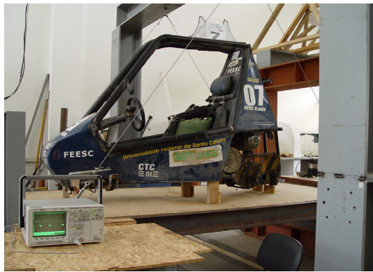
Figura 4.28: Medição do momento de inércia em torno do eixo transversal.
