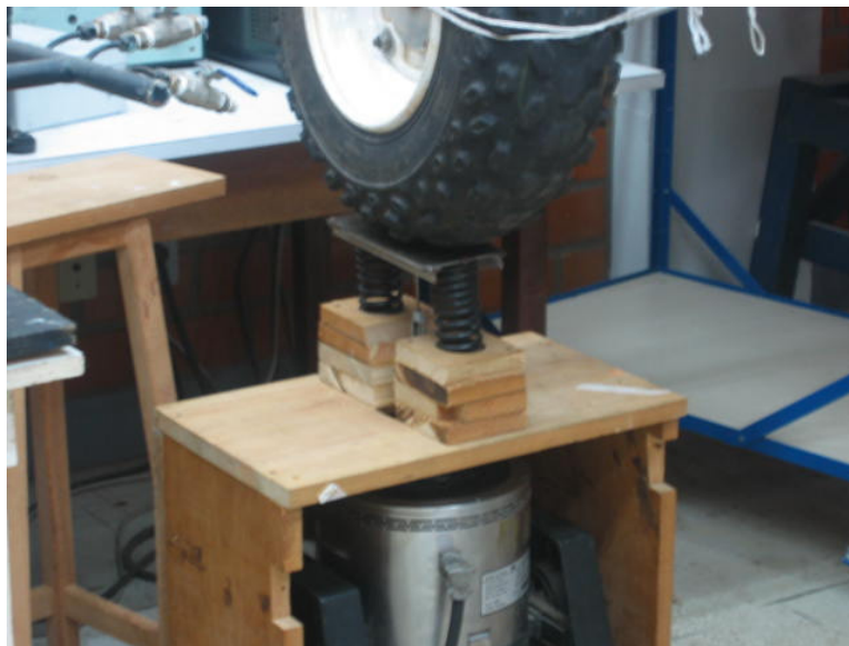
Figura 5.2: Dispositivo para aplicação de carga utilizado no ensaio experimental.
