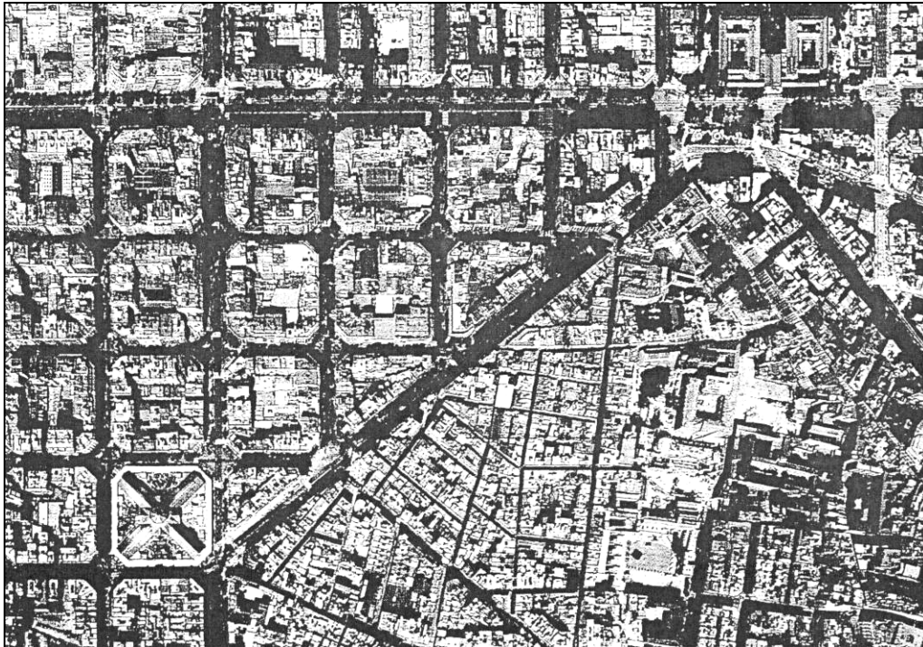
Figura 21: Vista aérea atual de Barcelona: verificação da aplicação real e parcial do Plano Cerdà e sua comparação com a malha do centro histórico de Barcelona. Fonte: FUNDACIÓ CATALANA PER A LA RECERCA. Catálogo de la Exposición Cerdá. Ciudad y Territorio: una visión de futuro . Barcelona, 1995, p. 28.
