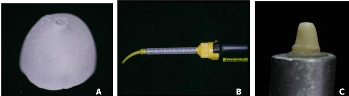
Figura 9 - A – Molde perfurado; B – Dispositivo responsável pela injeção da resina ao molde;
