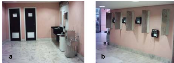
Figura 22: a) Bebedouros e pias em alturas diferentes; b) Telefones públicos dispostos em alturas diferentes, que possibilita uso pelos deficientes físicos.
