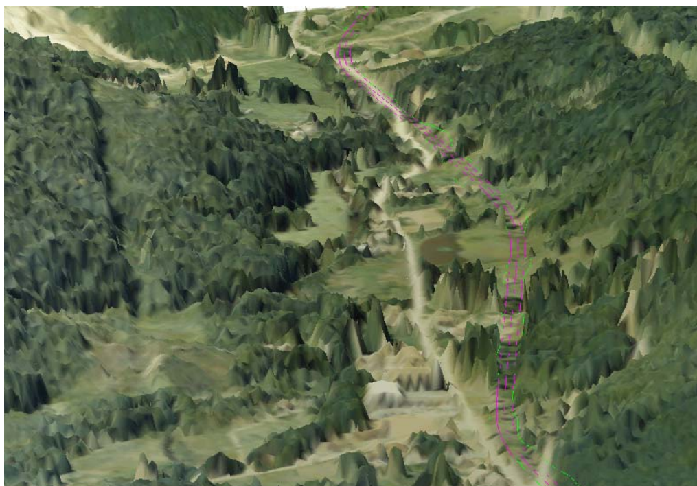
Fig. 41 – Visualização 3D da combinação do mosaico de ortofotos com o MDE obtido a partir dos pontos Laser Scanner e projeto geométrico da rodovia.
