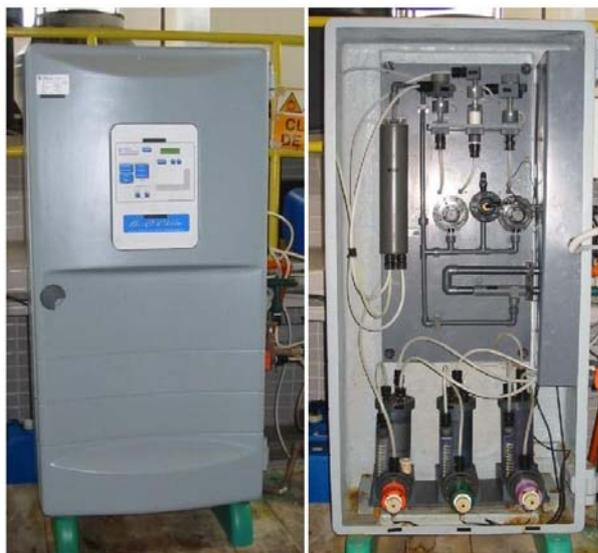
**FIGURA 22** – Gerador de dióxido de cloro utilizado durante os ensaios.
