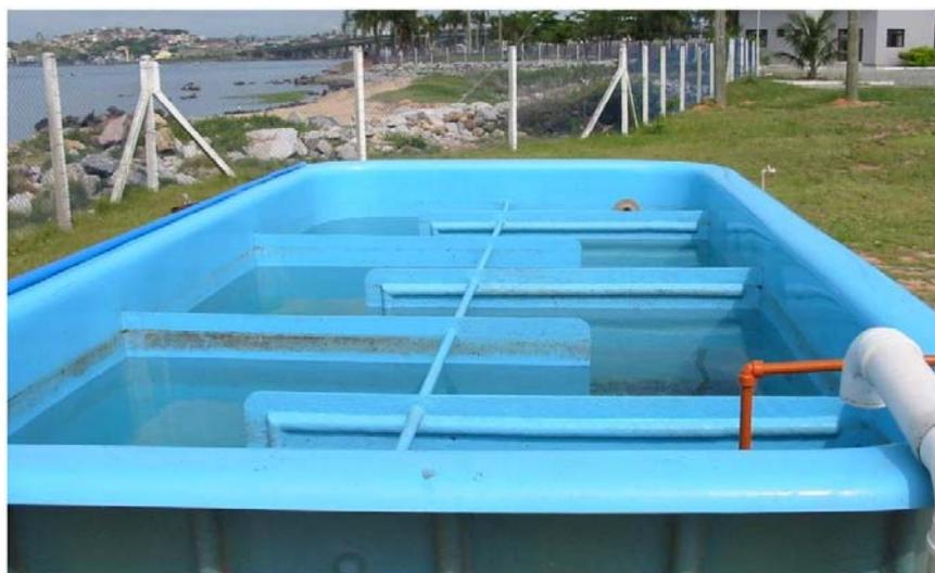
**FIGURA 25** – Chicanas utilizadas para a homogeneização dos fluídos.
