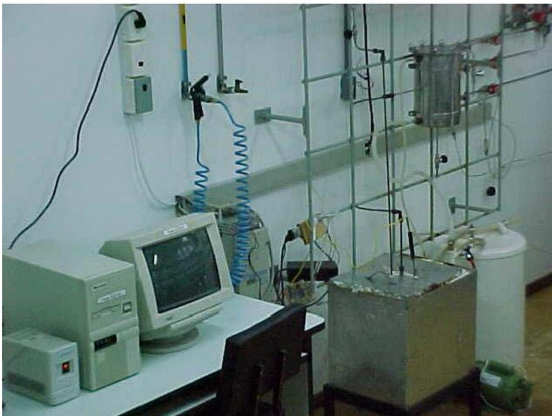
Figura 5-2 - Foto do sistema de pirólise com reator de 8 L.
