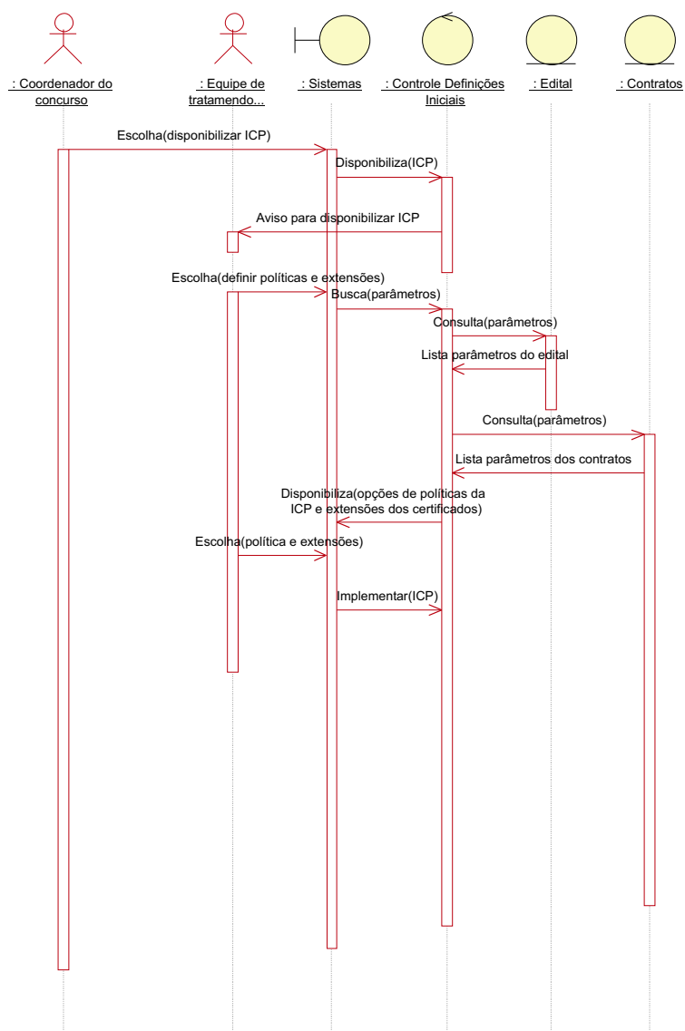
Figura C.16: Diagrama 4 de seqüência do use case definições iniciais com ICP
