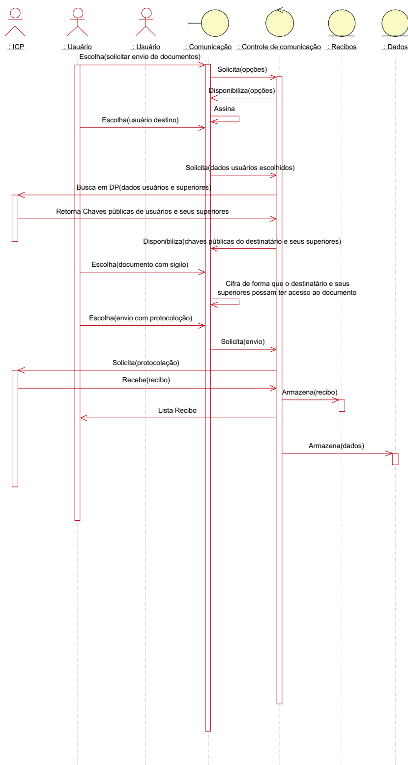
Figura C.5: Diagrama 1 de seqüência da comunicação e armazenamento seguro
