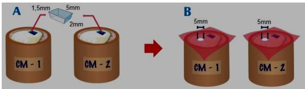
Figura 2 - Desenho esquemático representativo da metodologia aplicada no preparo das amostras onde associou-se microinfiltração e cisalhamento. 2A- Cavidades preparadas para os ensaios de microinfiltração. 2B- Cobertura com papel contact e delimitação da área de condicionamento e aplicação do sistema de união.
