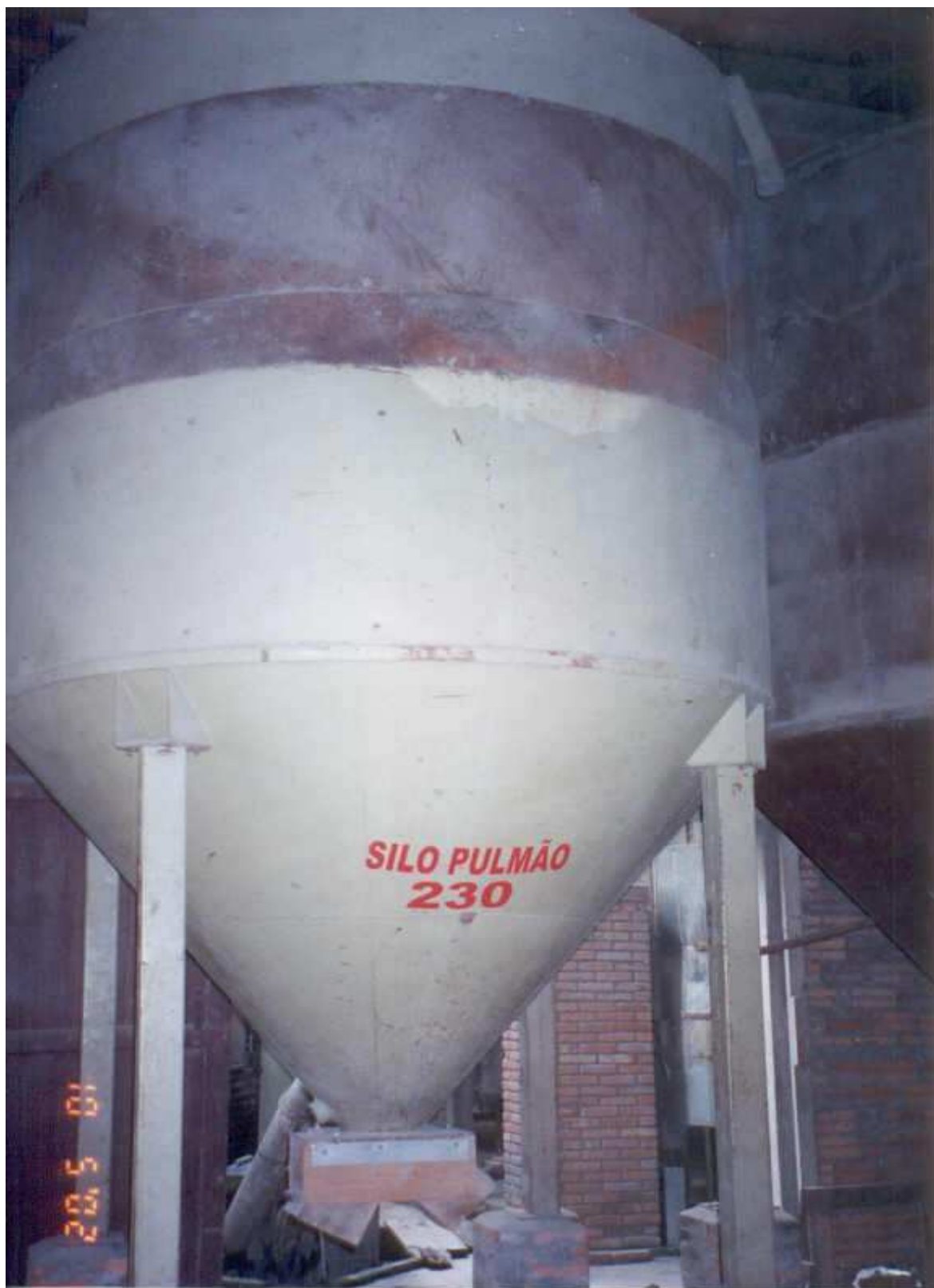
Figura 3.14: Armazenamento no “silo pulmão”.
