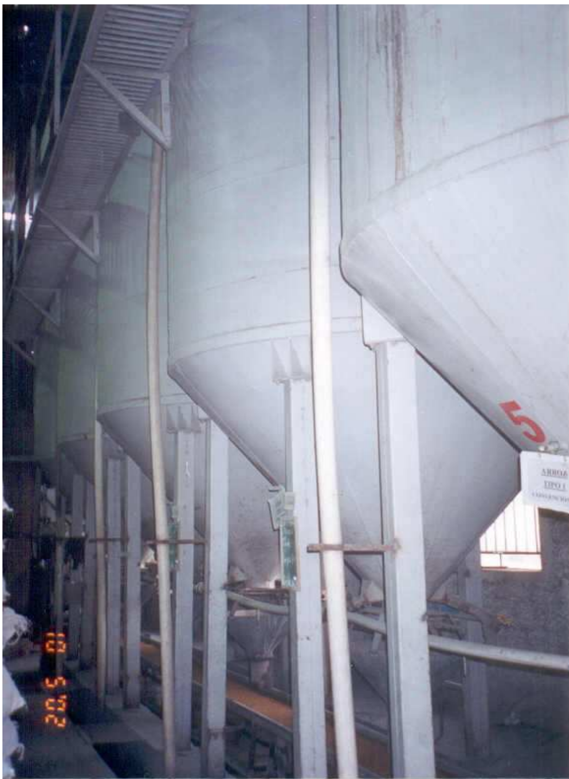
Figura 3.16: Tanques de cozimento para parboilização.
