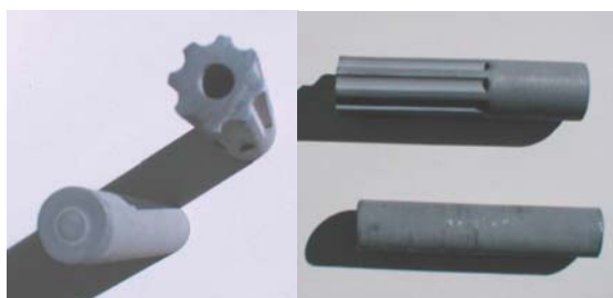
Figura 14 – Elementos porosos de parede lisa e ranhurada.
