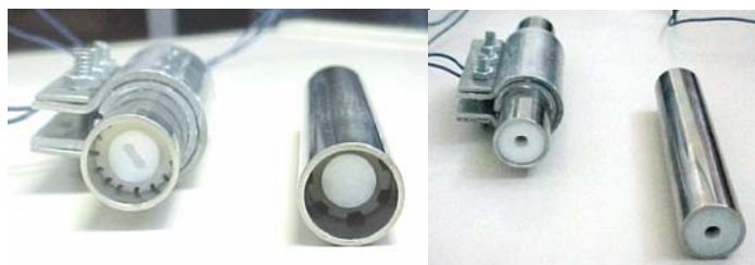
Figura 37 – Bombas capilares de elemento poroso: Polietileno e aço inoxidável.
