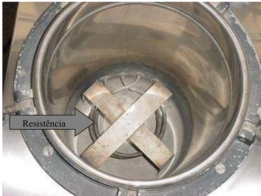
Figura 5.5 - Resistências da autoclave vertical.
