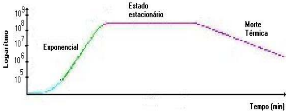
Figura 2.1 - Curva de morte térmica para microrganismos.
