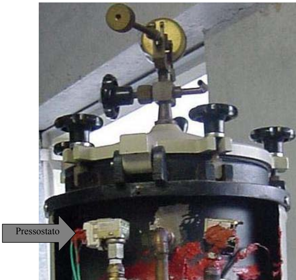
Figura 5.11 - Montagem do pressostato de segurança.
