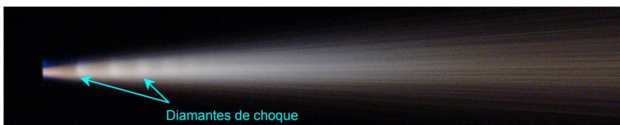
Figura 2.8 – Nuvem de gases (“plume”) formada a partir do bico de uma pistola HVCW (sistema HVw 2000) durante a aspersão de Hastelloy C-276, para um avanço de arame de 1,6 m/min. Imagem obtida com câmara fotográfica digital de alta velocidade [77].
