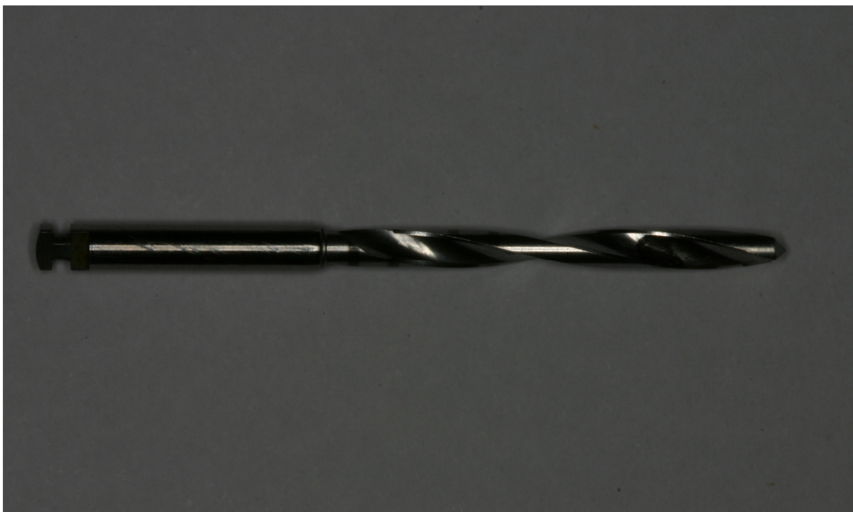
Figura 6 - Broca twist drill de 2,0mm de diâmetro utilizada na perfuração do corpo de prova.
