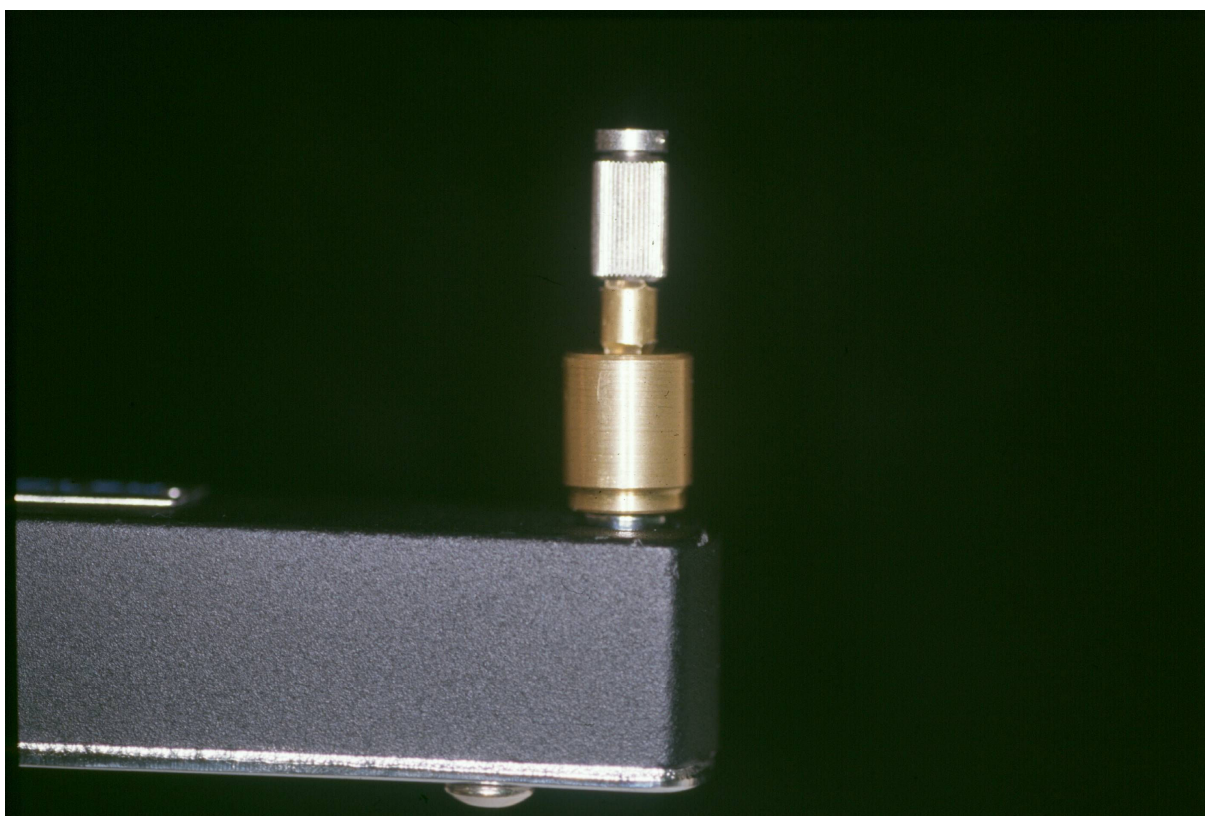
Figura 13 - Torquímetro adaptado a chave digital através de um dispositivo metálico.
