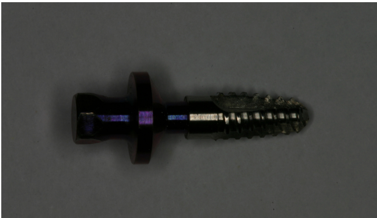
Figura 8 - Macho de rosca para implantes Osseotite NT MicroMini, de 3,25x 8,5mm, da marca 3i, para confecção das roscas das perfurações do corpo de prova.
