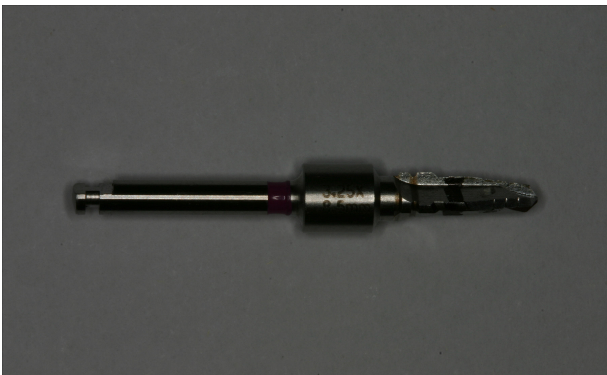
Figura 7 - Broca para implantes Osseotite NT MicroMini de 3,25x 8,5mm, da marca 3i, utilizada para formação cônica das perfurações do corpo de prova.
