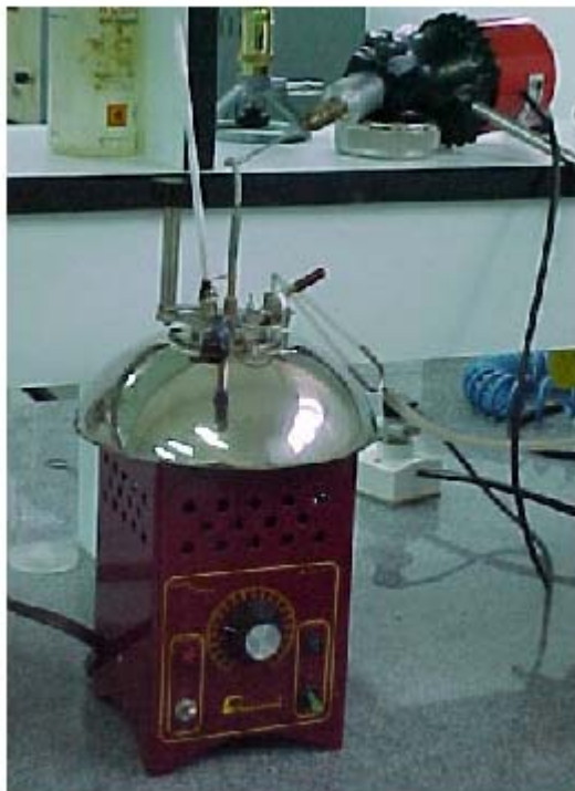
Figura 6-5 Ponto de fulgor pelo método Pinsky-Martens ASTM D-93 MB-48 modelo PD-530 e 540
