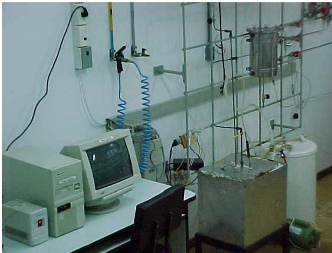
Figura 6-2 Foto do sistema pirolítico usado para aquisição on line de dados de energia
