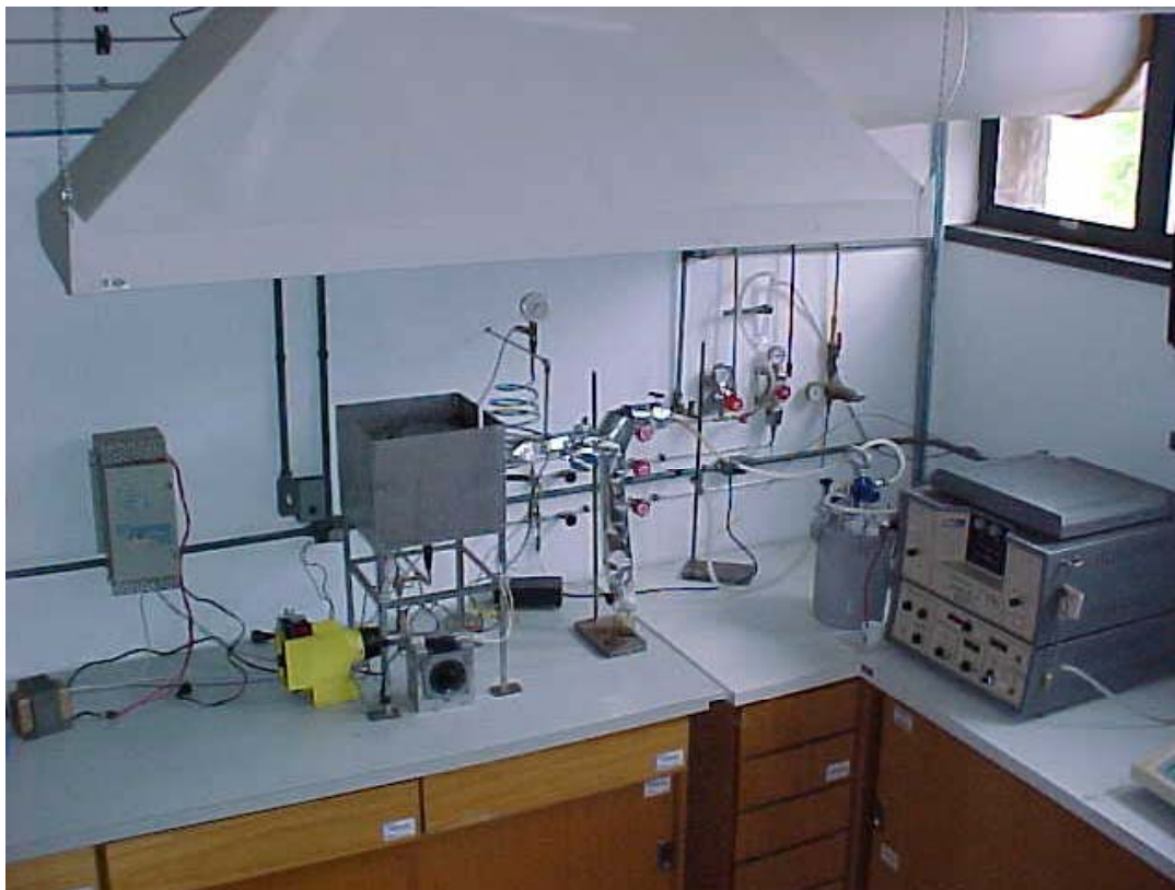
Figura 6-1 Aparato experimental constituído por retorta, vaso separador e sistema de análise
