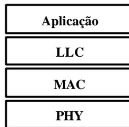
Figura 3.1: Arquitetura em camadas de uma rede industrial clássica
